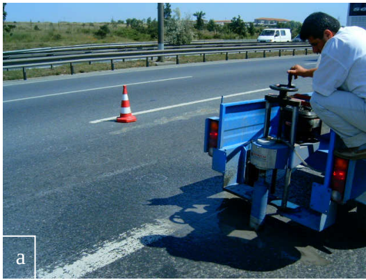
Şekil 3.11.a,b: TMA kaplamadan karotların alınması
