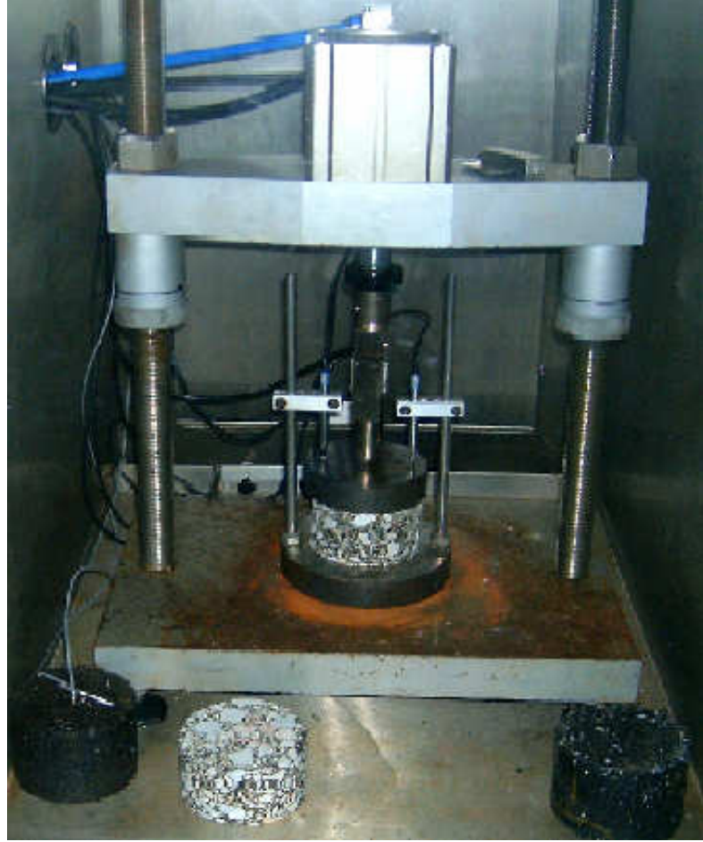
Şekil 4.10: Statik sünme deney düzeneği ve numunenin yüklenmesi
