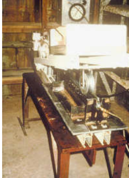
Şekil 2.30: Georgia tekerlek izi cihazı (Kandhal ve Cooley, 2002)
