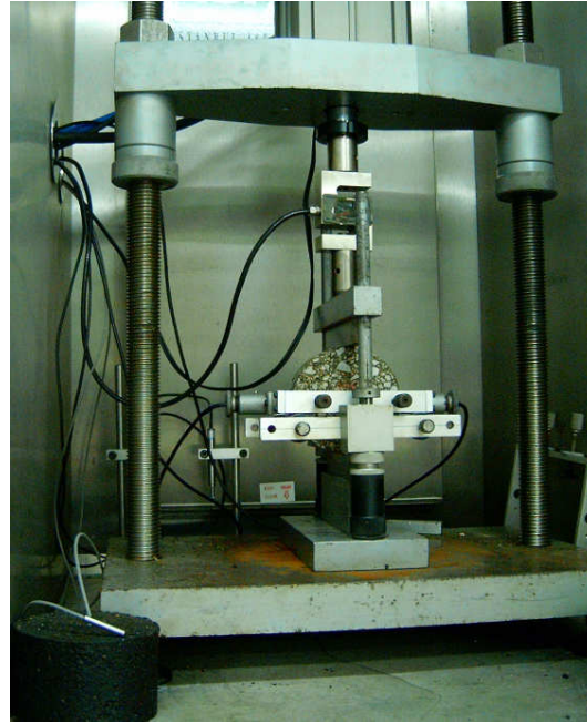
Şekil 4.24: Dolaylı çekme modülü deney düzeneği ve numunenin yüklenmesi
