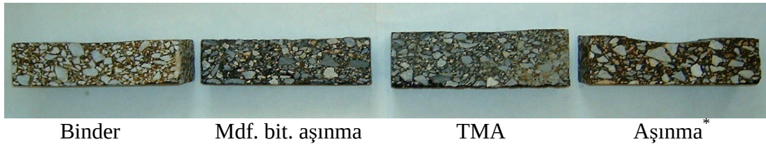
Şekil 6.4: Tekerlek izi deneylerinden sonra numunelerden alınan kesitler (50 °C)
