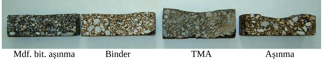
Şekil 6.8: Tekerlek izi deneylerinden sonra numunelerden alınan kesitler (60 °C)
