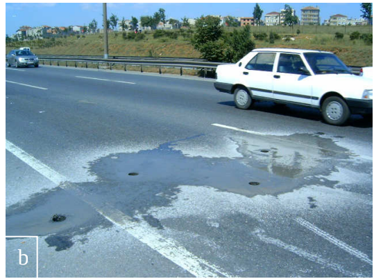
Şekil 3.11.a,b: TMA kaplamadan karotların alınması
