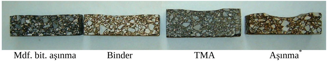
Şekil 6.6: Tekerlek izi deneylerinden sonra numunelerden alınan kesitler (55 °C)
