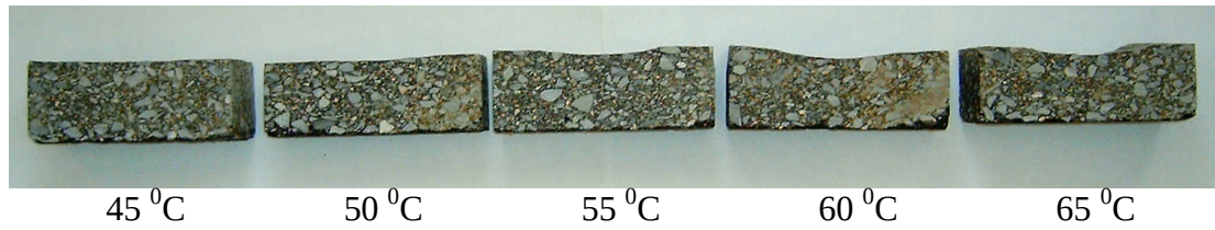
Şekil 4.7: Tekerlek izi deneylerinden sonra TMA numunelerinden alınan kesitler
