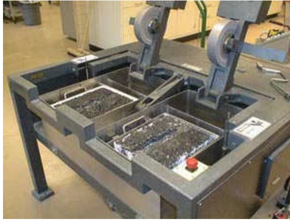
Şekil 2.32: Hamburg tekerlek izi cihazı ( www.fhwa.dot.gov )
