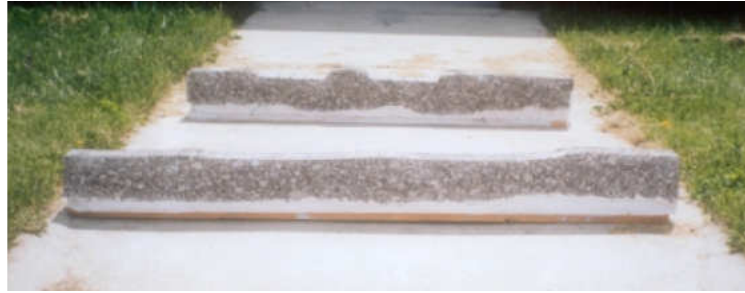
Şekil 2.19: Gezinti miktarına göre tekerlek izi oluşumu (enkesit) (White ve diğ. 2003)
