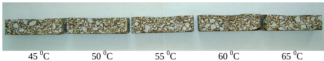
Şekil 4.5: Tekerlek izi deneylerinden sonra binder numunelerinden alınan kesitler
