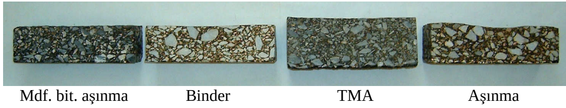
Şekil 6.2: Tekerlek izi deneylerinden sonra numunelerden alınan kesitler (45 °C)
