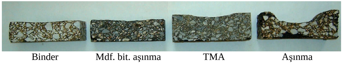
Şekil 6.10: Tekerlek izi deneylerinden sonra numunelerden alınan kesitler (65 °C)
