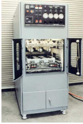
Şekil 2.31: APA Tekerlek izi cihazı ve yakından görünüşü (Kandhal ve Cooley, 2002)
