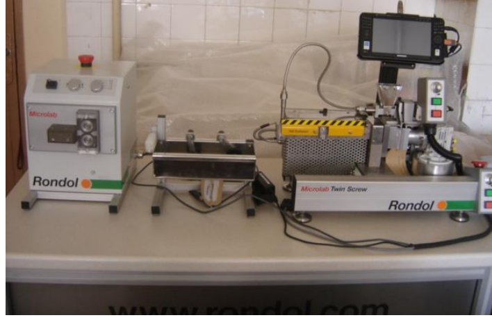
Şekil 3.2. Çift vidalı ekstruder hattı
