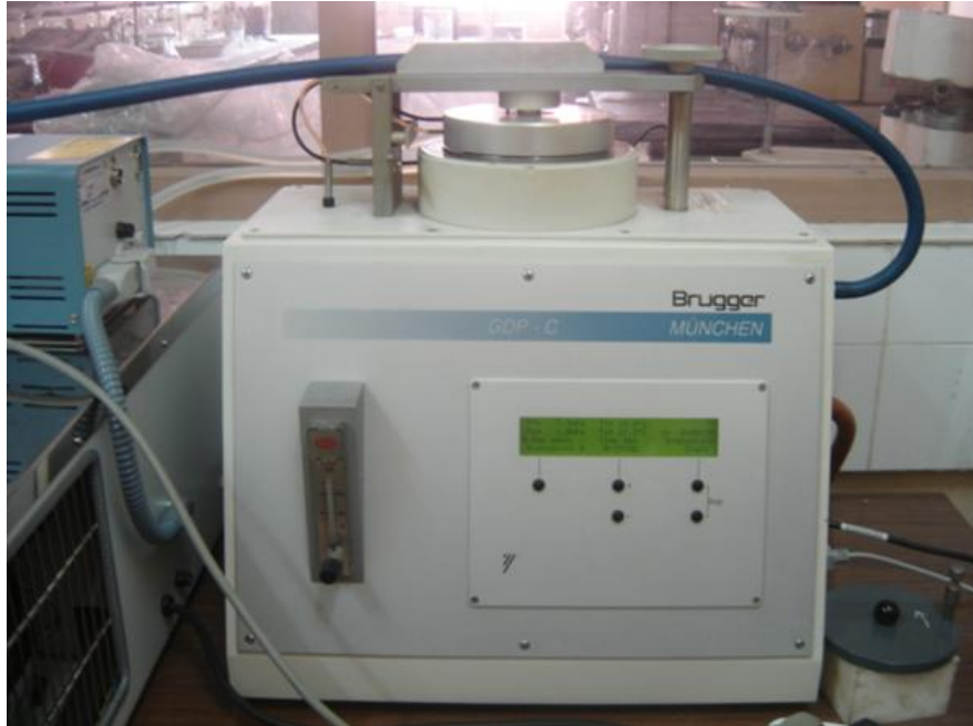
Şekil 3.5.ASTM D1434 yöntemine göre ölçüm yapan Gaz Geçirgenlik Test Sistemi
