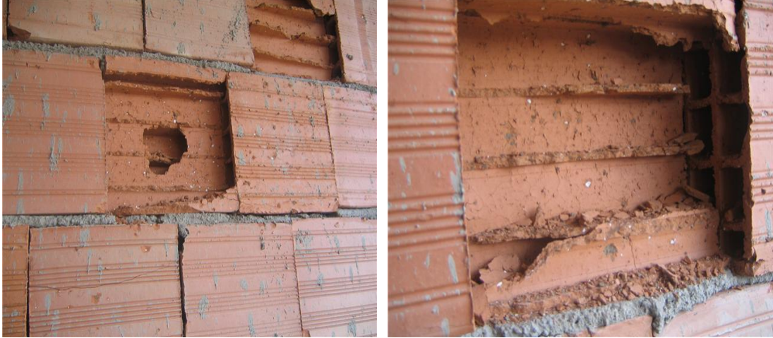
Şekil 3.1 Bay-Kes tuğla fabrikasının mukavemet problemi olan ürünleri [32].
