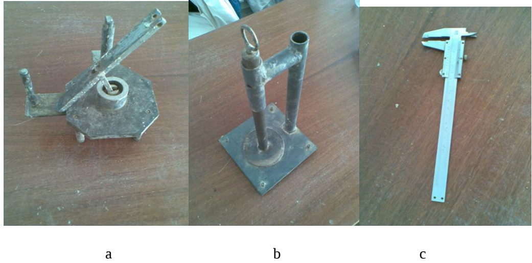
Şekil 6.1 Pfefferkorn plastiklik testinin yapıldığı aparatlar.
