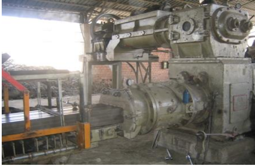
Şekil 3.5 Bay-Kes fabrikası ekstrüzyonunun görünümü [32].
