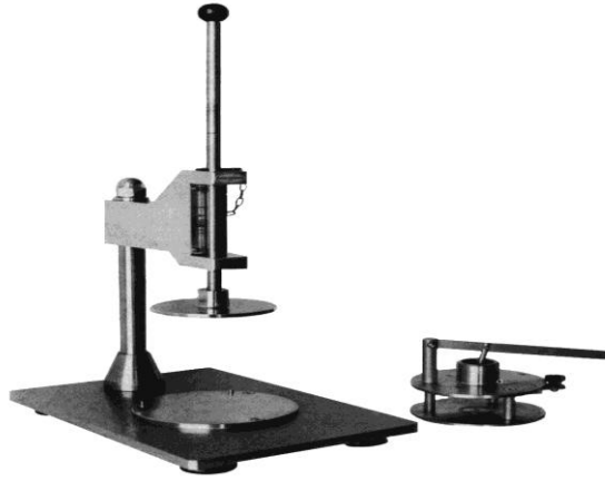
Şekil 3.4 Plastiklik ölçen Pfefferkon cihazının resmi [34].
