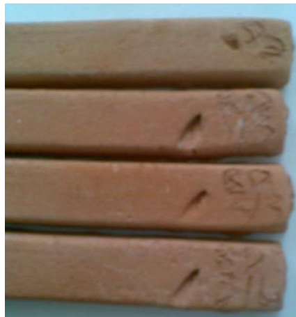
Şekil 7.20 Reçetelerin pişmiş numuneleri. (Yukarıdan aşağıya sırasıyla ekstrüzyon girişi, reçete 1, reçete 2 ve reçete 3 verilmiştir).
