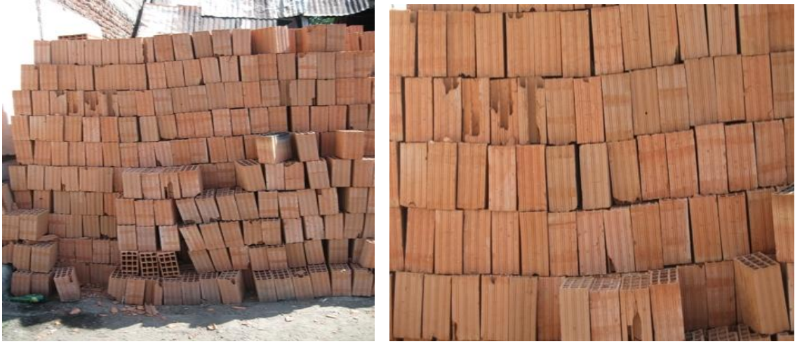
Şekil 3.10 Bay-Kes fabrikasının renk problemi olan ürünlerinin görüntüsü [32].
