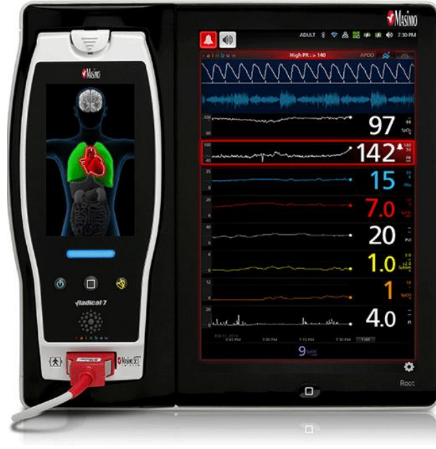
Resim 3: PI ve PVI Ölçümünü Sağlayan Cihaz
