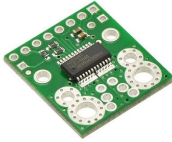
Şekil 3.20: Akım ve voltaj ölçüm devresi
