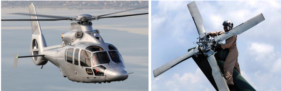
Şekil 1.12: a) Eurocopter tarafından üretilen EC 155 helikopteri kanal içi fan tasarımlı anti-tork sistemi [16] b) Sikorsky tarafından üretilen Blackhawk helikopterin 4 palli geleneksel açık kuyruk rotoru [17]
