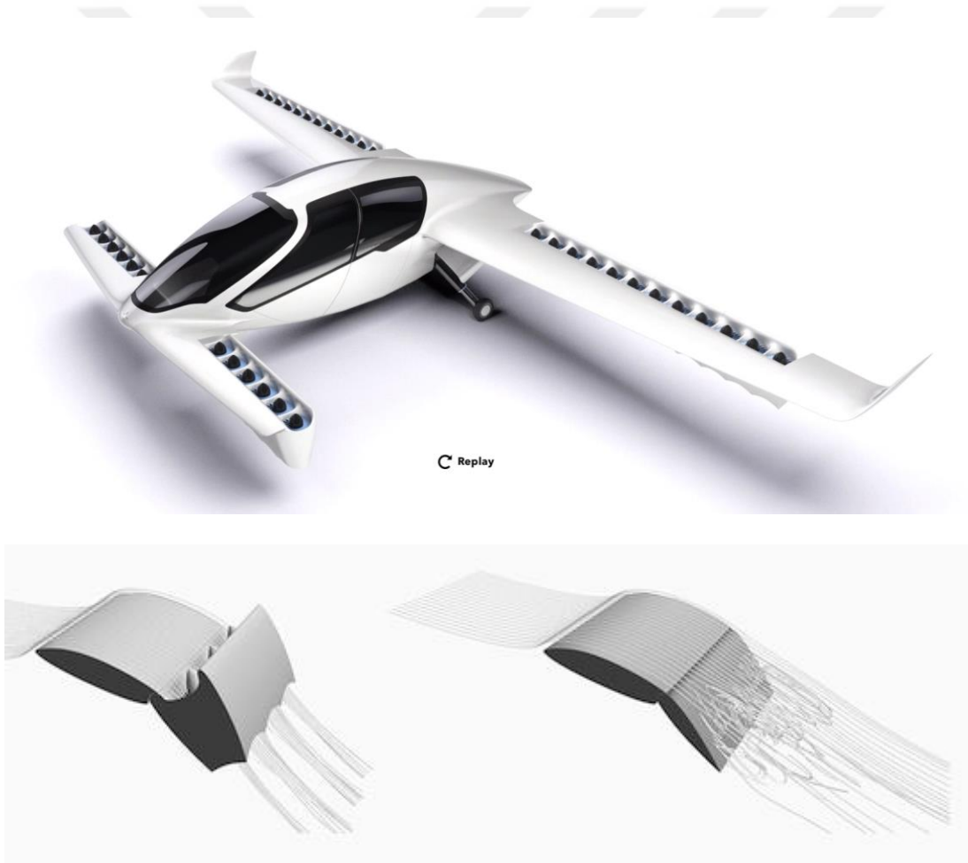
Şekil 1.3: Lilium jet kanat yapısı üzerindeki flap üzerine yerleştirilmiş çok sayıda kanal içi fan sistemi ile dikey kalkış ve iniş gerçekleştirebilmektedir. [4]
