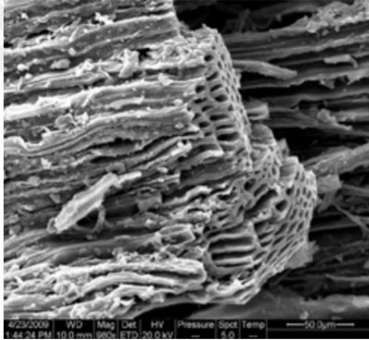
Şekil 2.2. Biyokömür'ın gözenekli yapısının elektron mikroskopunda görünümü (Downie vd., 2012)
