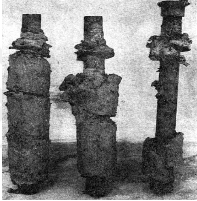
Şekil 2.31: Çekme yüklerine maruz kalan helisel ankrajlar (Rao vd., 1991).
