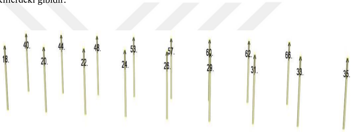
Şekil 3.13: Lutenegger (2016) düz kazık deneylerinin SAP2000’de modellenmesi.
