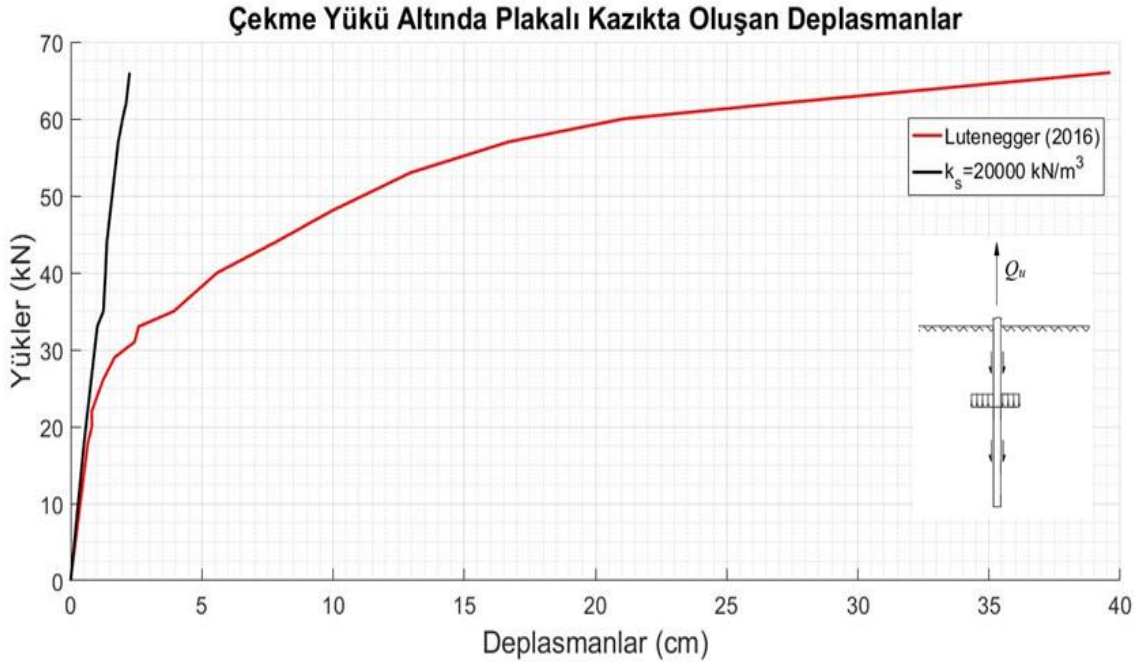
Şekil 4.13: SAP2000’de çekme yükü uygulanmış plakalı kazıkta meydana gelen deplasman.
