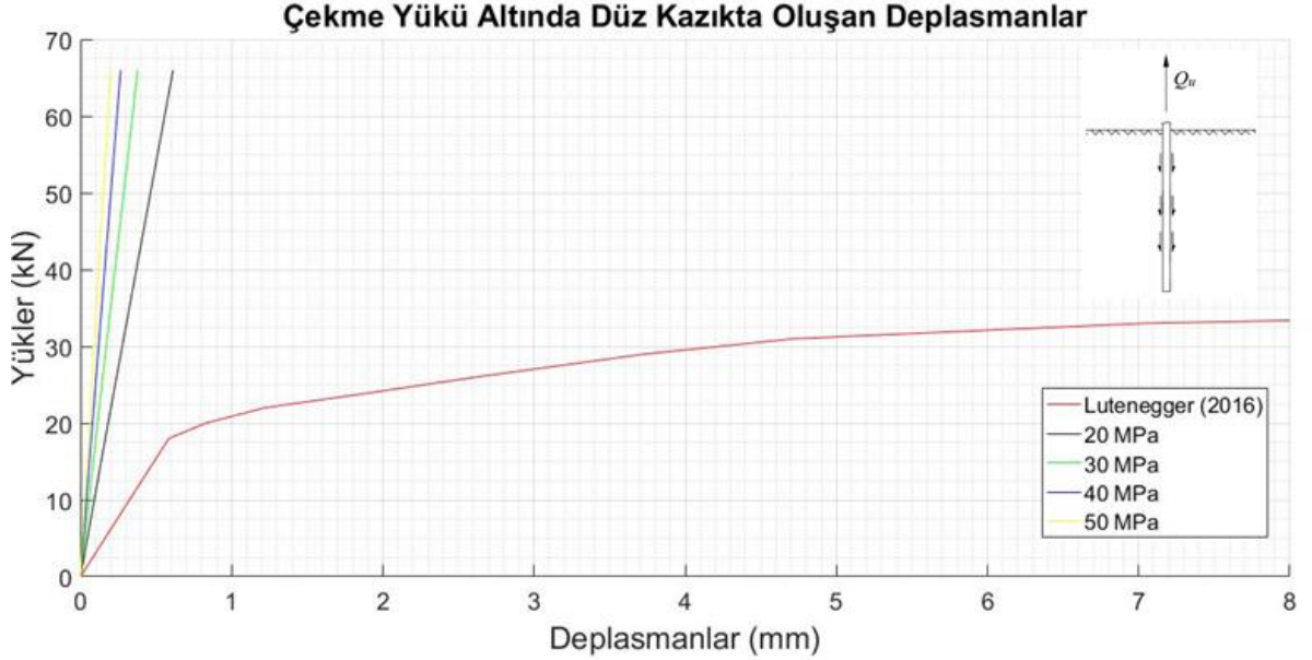
Şekil 4.11: SAP2000'de düz kazıkta meydana gelen deplasmanlar (Vesic 1961).
