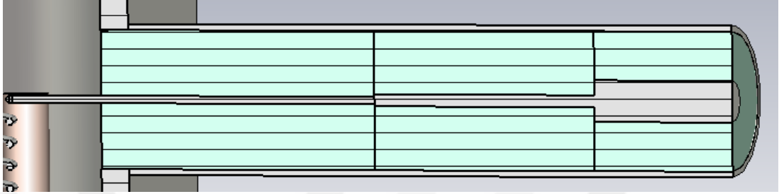
Şekil 4.38 Konektörde empedans geçiş kesitleri
