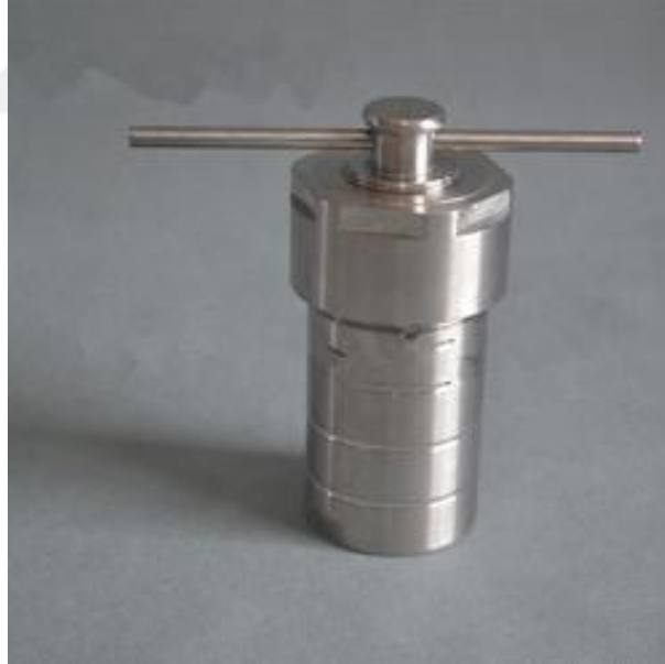
Şekil 5.1 SBA-15 ve CMK-3 numunelerinin sentezinde kullanılan hidrotermal kap
