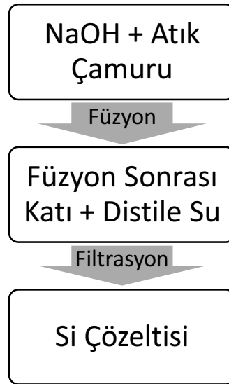
Şekil 5.2 Atık çamurundan füzyon yöntemi ile silisyum çözeltisi elde edilmesi yöntemi
