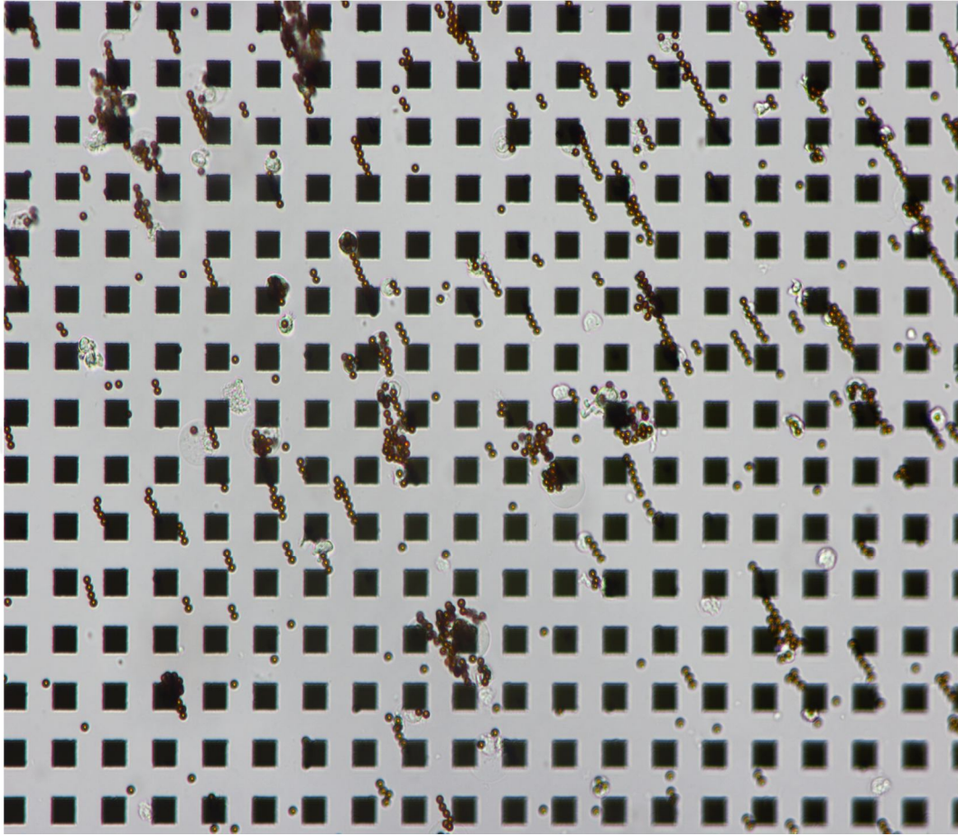
Şekil 18. Altın yüzeyler üzerinde bead-bağlı hücrelerin tutulması.
