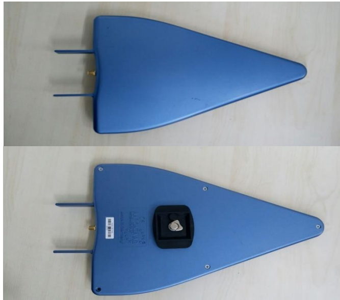
Şekil 4.17. Kazanç ölçümü yapılan referans anten
