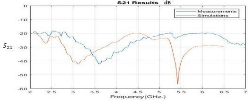
Şekil 4.9. AMC'li antenin S_{21} simülasyon ve ölçüm sonuçları grafiği
