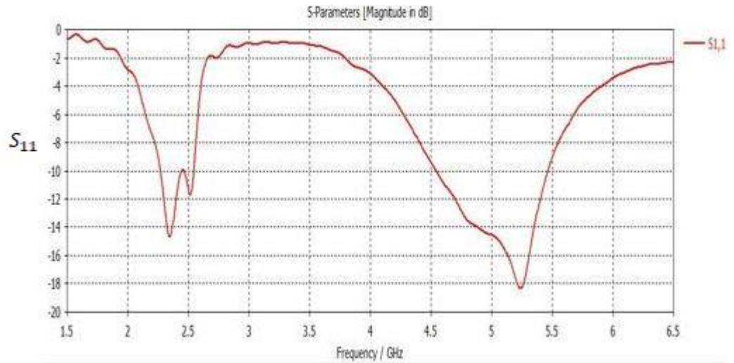
Şekil 4.1. AMC reflektörlü antenin S_{11} simülasyon sonucu
