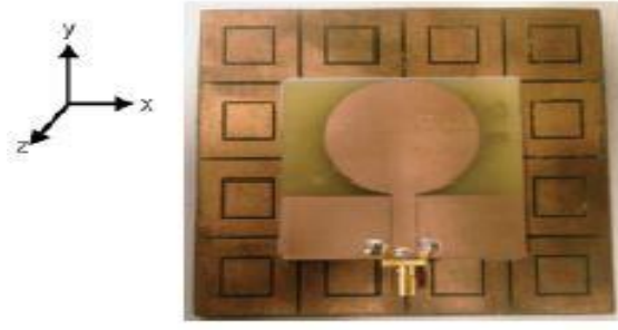
Şekil 2.5. AMC üzerinde fabrikasyon anten (Abbasi, 2010)
