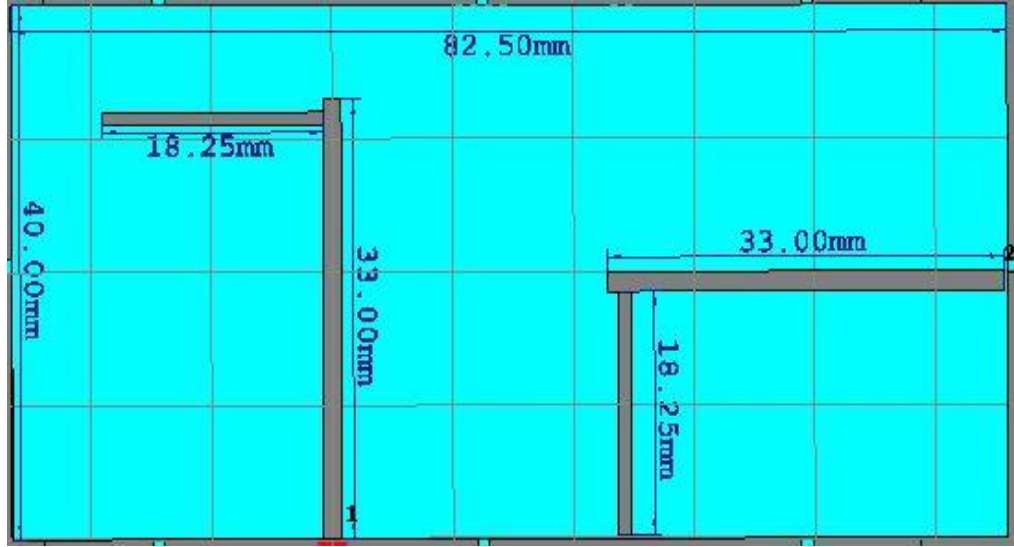
Şekil 3.11. 2.45 GHz ve 5.8 GHz frekansında çalışan anten geometrisi ve boyutları
