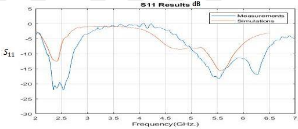
Şekil 4.8. AMC'li antenin geri dönüş kaybı simülasyon ve ölçüm sonucu
