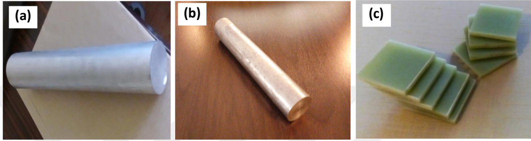
Şekil 3.1. Aşınma ve korozyon deney numunelerinin talaşlı imalat yoluyla elde edildięi ilk numuneler, a) AZ 91 Mg alařımı, b) Etial 150 Al alařımı, c) FR-4 cam takviyeli plakalı epoksi malzeme
