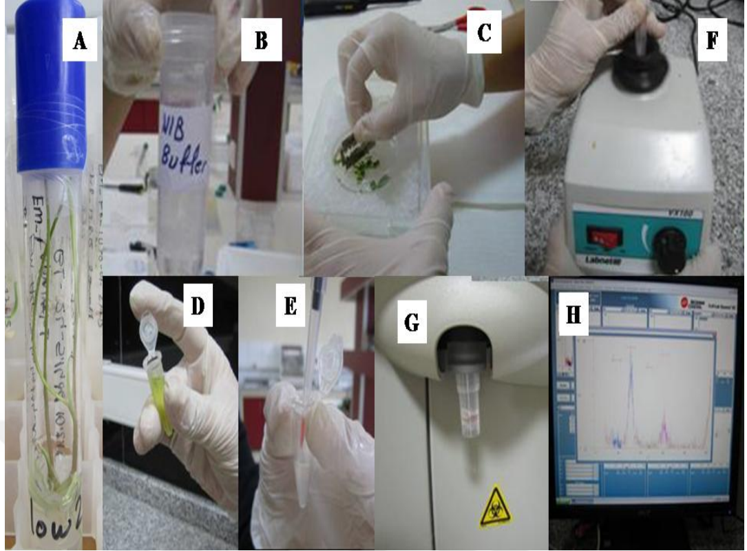
Şekil 3: Flow sitometri cihazı ile A.ampeloprasum bitkilerinde DNA miktarı ve ploidi düzeylerinin belirlenmesi
