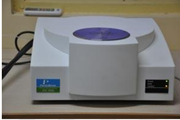
řekil 3.6 Perkin Elmer marka DSC
