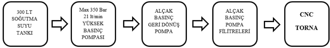
Şekil 3.7.Yüksek Basınç Jet Soğutma sisteminin yapısı
