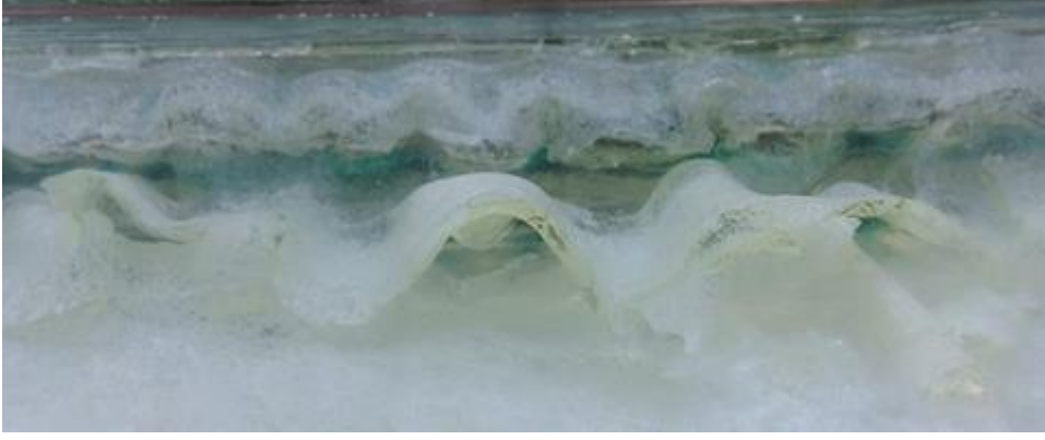
Şekil 3.4. Kaplama yapılan silikonda benzin çözünmesi ile oluşan tahribat
