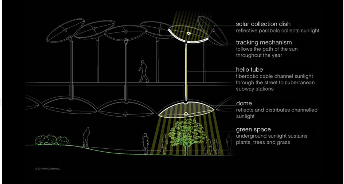
Şekil 3.11 : Güneş Enerjisi Sistemi (URL-5).
