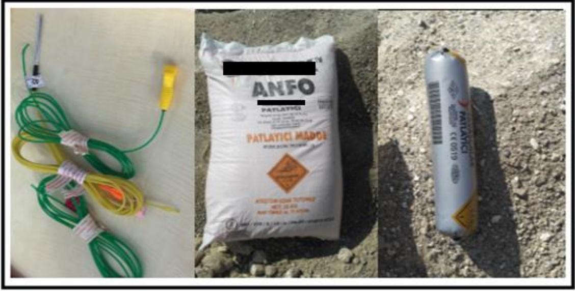
Şekil 5.4. Patlatma işleminde kullanılan kapsül, ANFO ve dinamit.
