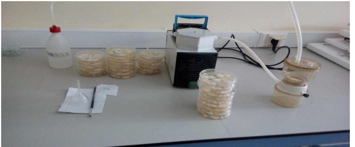
Şekil 3.4. Beauveria bassiana sporlarının toplanmasında kullanılan vakum düzeneği.
