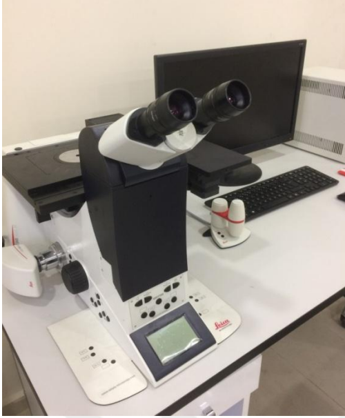
Resim 7.7. Leica DMI 5000M optik mikroskop
