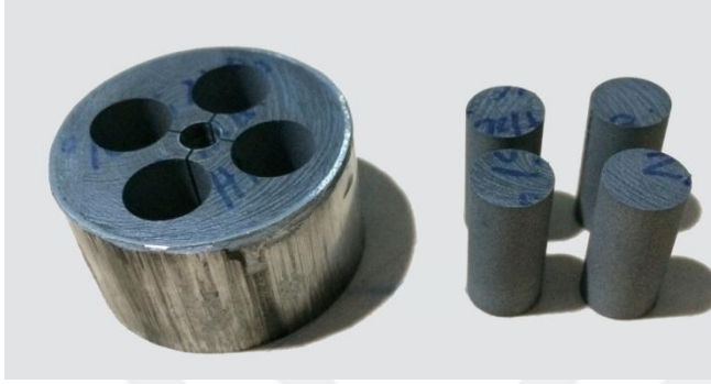
Resim 7.5. Tel erozyon ile kesilmiş aşınma test numuneleri
