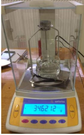
Resim 7.4. Yoğunluk kiti yerleştirilmiş hassas terazi
