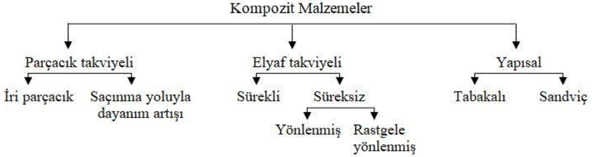
Şekil 3.1. Kompozit malzemelerin takviye elemanlarına göre sınıflandırılması [16]
