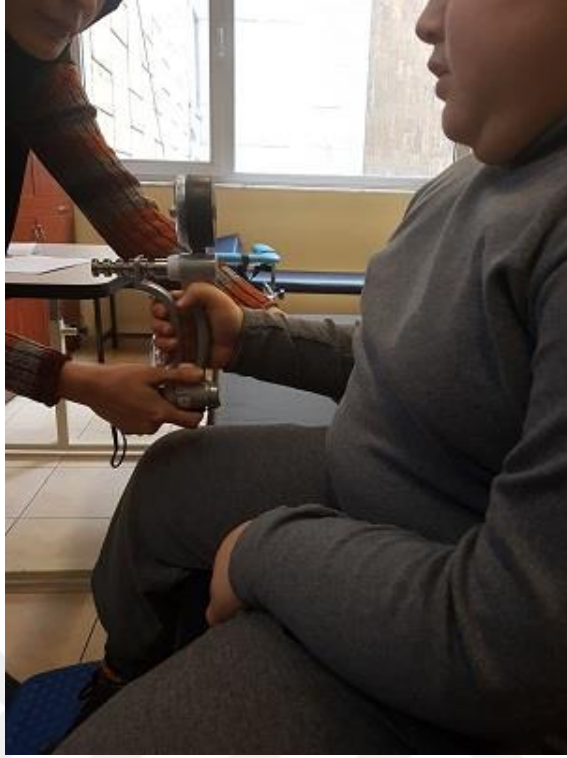
Şekil 3.2. Jamar El Dinamometresi ile kaba kavrama kuvvetinin değerlendirilmesi.
