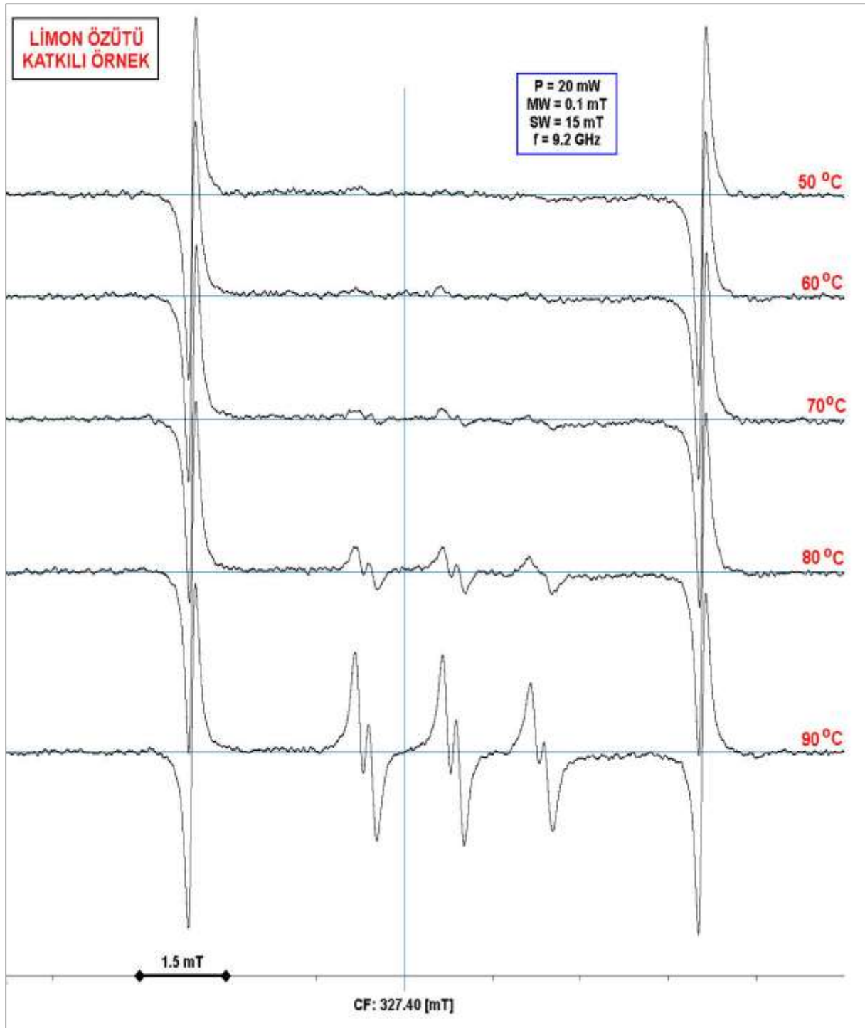
Şekil 4.6. Limon özütü katkılı örneğin 50°C ile 90°C sıcaklıkları arasında ESR spektrumları
