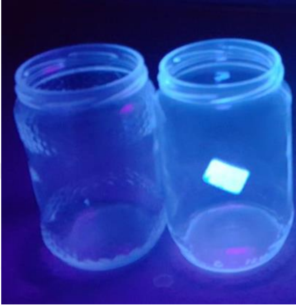
Şekil 7.2. İki farklı oksit katkı içeren cam kavanoz ürünlerin UV ışık altında görüntüleri.
