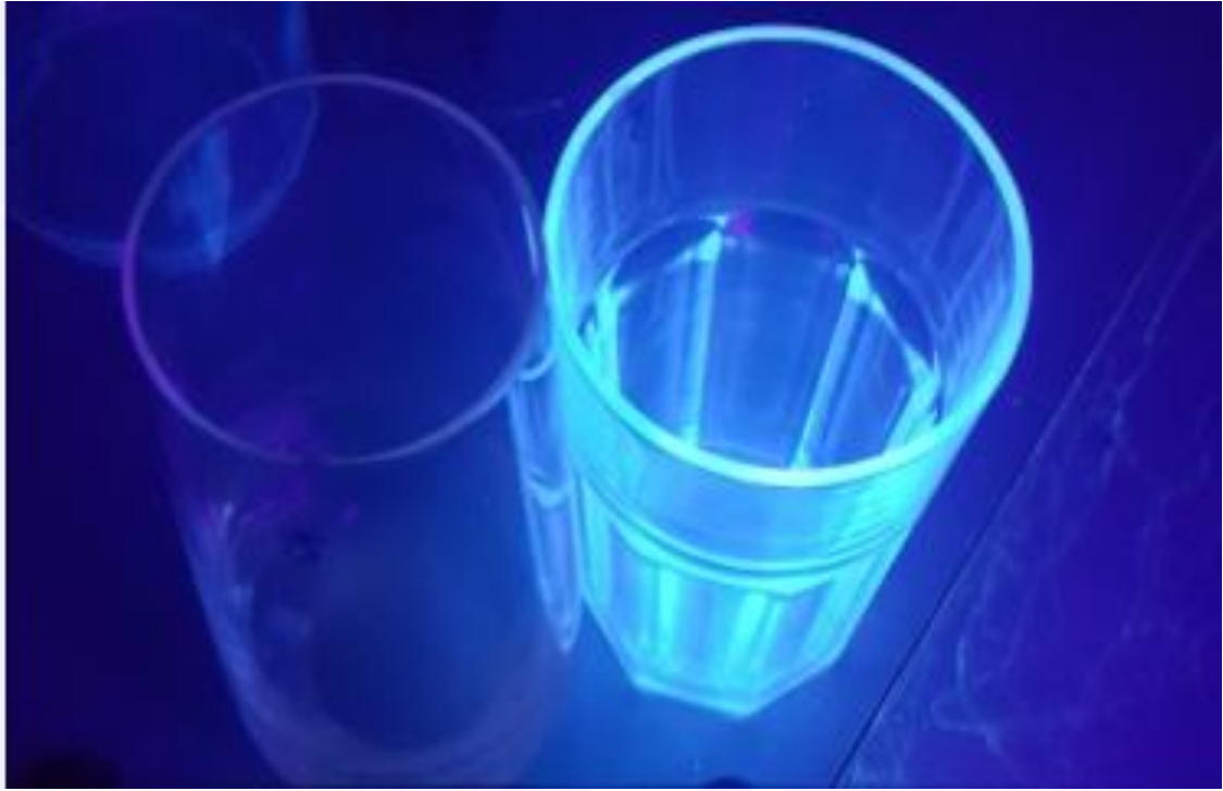
Şekil 7.1. İki farklı oksit katkı içeren cam bardak ürünlerin UV ışık altında görüntüleri.
