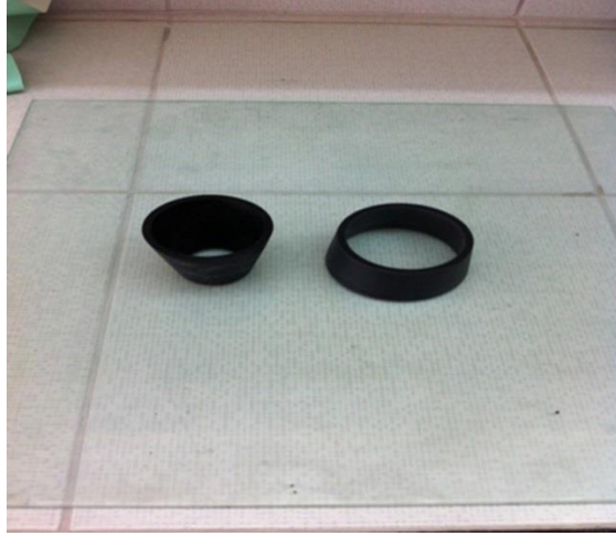
Şekil 4.5. Kantro mini-çökme deney konisi (sol); DIN EN 1015'e uygun koni (sağ)
