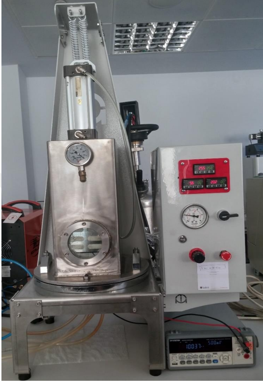
Şekil 3.5: Termoelektrik modül test cihazı
