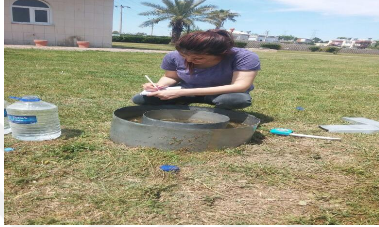
Şekil 3.7. Çift Silindir İnfiltrometre ile Su Alma Hızının Belirlenmesi
