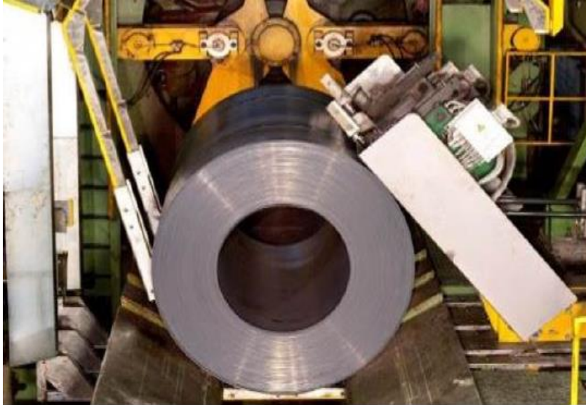
Şekil 2.20 : Bobin sarma ünitesinde sarılmış bobin.
