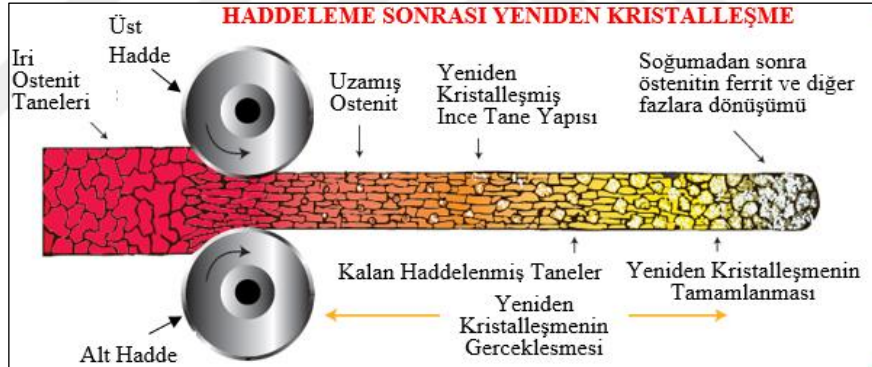
Şekil 1.4 : Sıcak haddeleme sonrası yeniden kristallenme işlemi [26].
