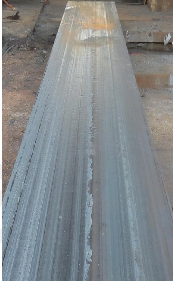
řekil 4.11 : %0,030 Al ilaveli azotlu vanadyum mikro alařımlı elikte normal slab yüzeyi.
