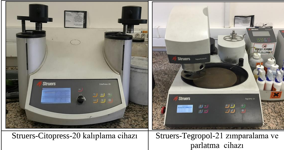
Şekil 4.20 : Struers-Citopress-20 kalıplama cihazı ve Struers-Tegropol-21 zımparalama ve parlatma cihazı.
