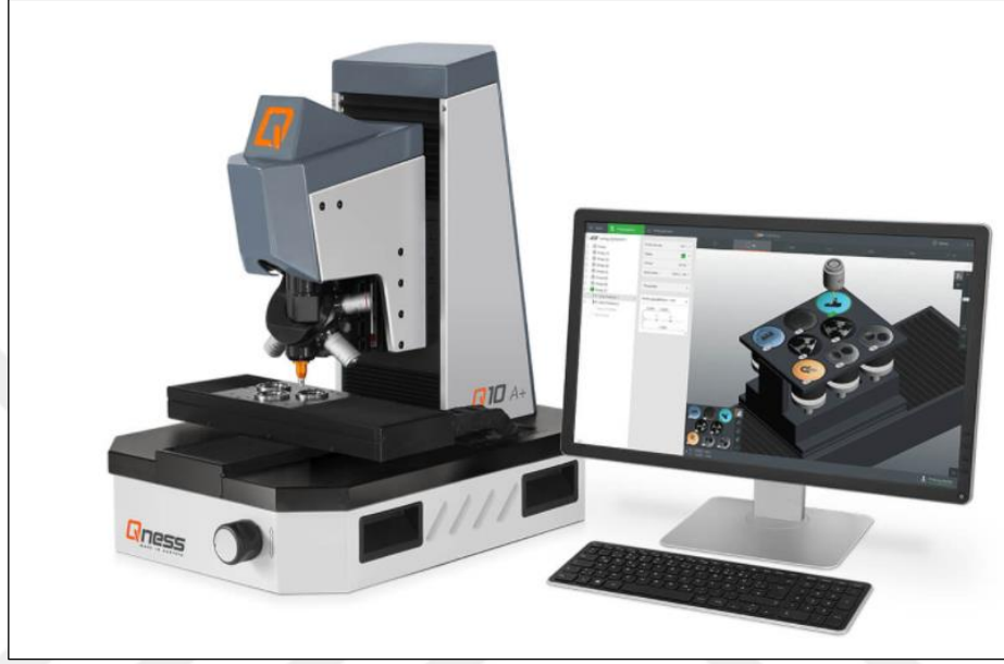
Şekil 4.31 : Qness Q10 mikro sertlik cihazı.
