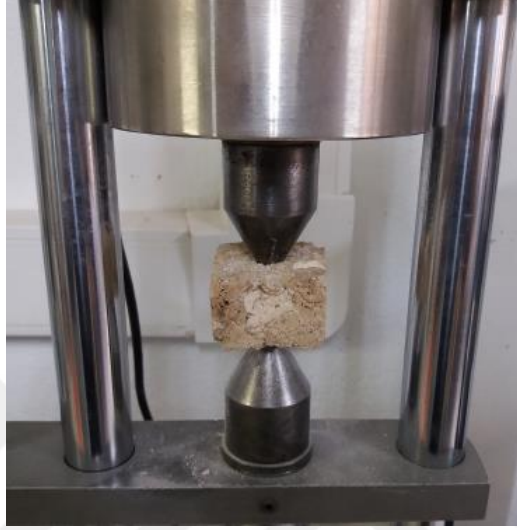
Şekil 4.11. Kayacın içine batan (gömülen) konik başlıklar
