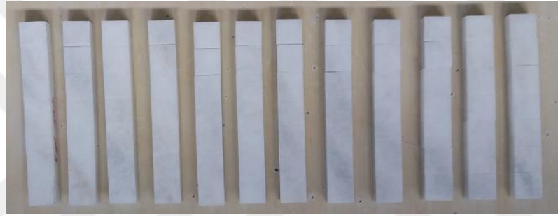
Şekil 3.6. 350×50×30 mm'lik prizmatik örnekler
