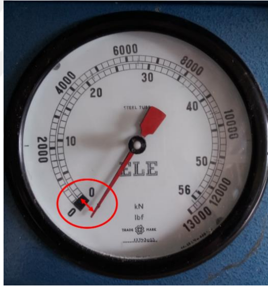
Şekil 4.3. Sıfırdan başlamama (kalibrasyon) hatası
