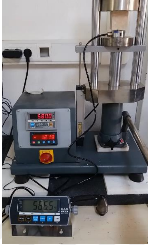
Şekil 3.10. Deney cihazı kalibrasyon kontrolü
