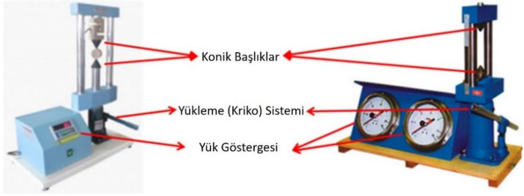
Şekil 1.10. Bazı klasik (mevcut) nokta yükleme dayanımı deney cihazlarının görünüşü
