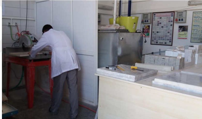
Şekil 3.4. Nokta yükleme dayanımı deneyleri için örnek hazırlama işlemi
