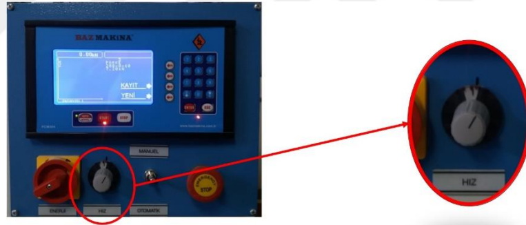
Şekil 5.53. Kontrol paneli üzerinde bulunan hız (potansiyometre) düğmesi
