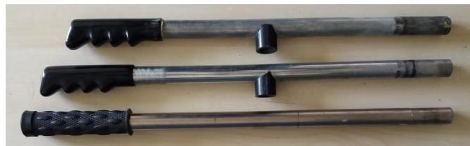
Şekil 4.12. Farklı deney cihazlarına ait yükleme kolları
