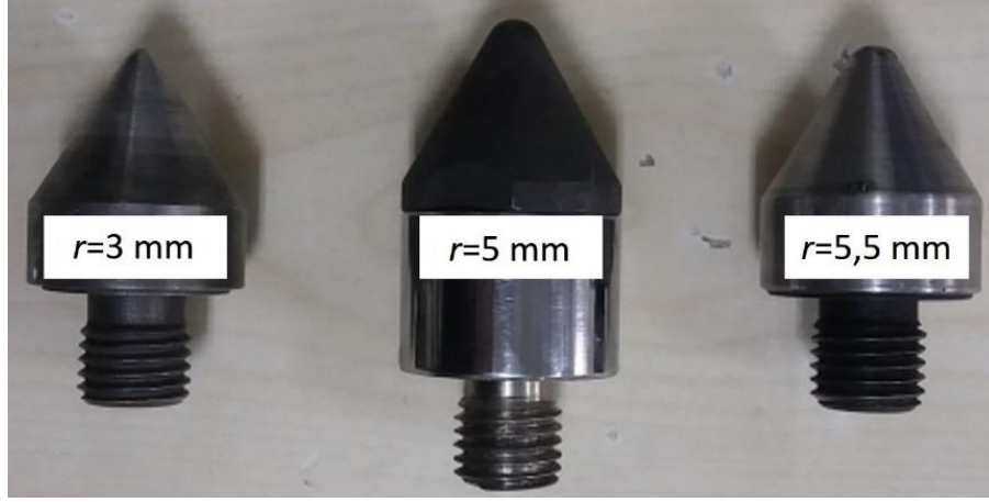
Şekil 5.32. YNY’de kullanılan farklı r (3-5-5,5 mm) değerine sahip konik başlıklar
