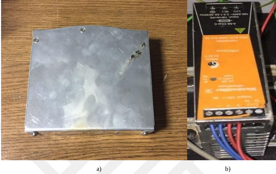
Şekil 4.14. a) yanan güç kaynağı b) yerine koyulan yeni güç kaynağı
