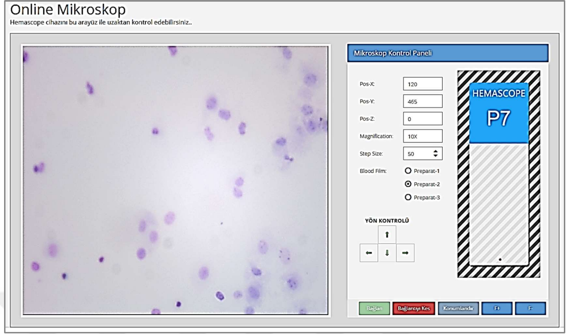
Şekil 7.19. Motorize mikroskop sisteminin gerçek zamanlı çalışabilen olarak uzaktan kontrol paneli.
