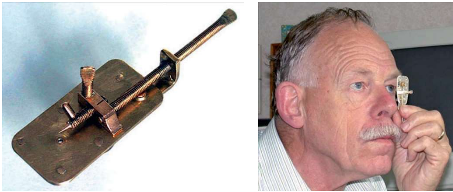
Şekil 6.1. Anton von Leeuwenhoek’un geliştirdiği mikroskop.
