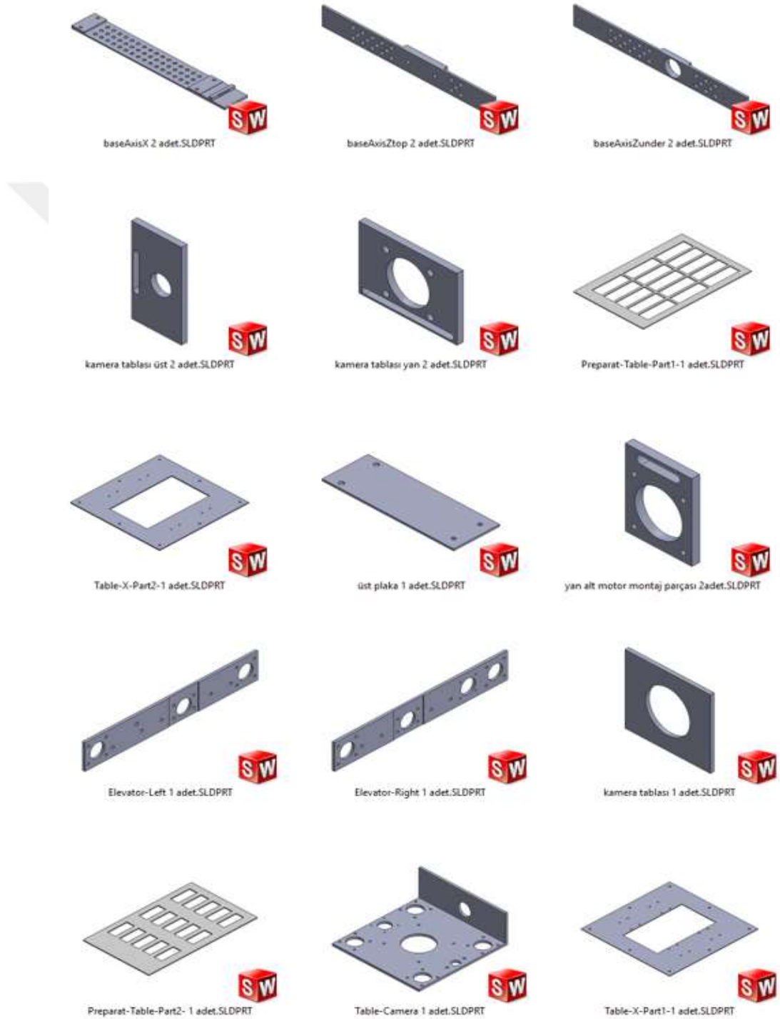
Şekil 6.12. Tasarlanan mekanik bağlantı parçaları.
