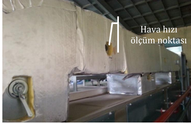
Şekil 3.12. Kurutma sisteminde hava hızı ölçüm noktalarına bir örnek
