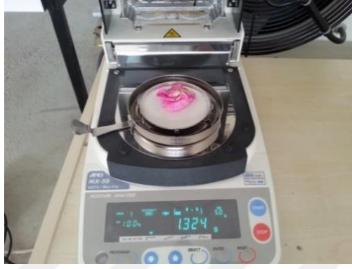
řekil 3.47. Eleme ile ayırma öncesi nem tayini
