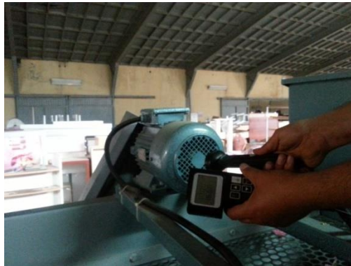
Şekil 3.39. Elek sistemi titreşim motoru devir sayısının ölçümü
