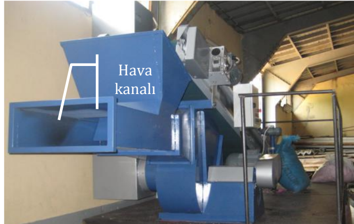
Şekil 3.4. Fan ve hava kanalı başlangıcı
