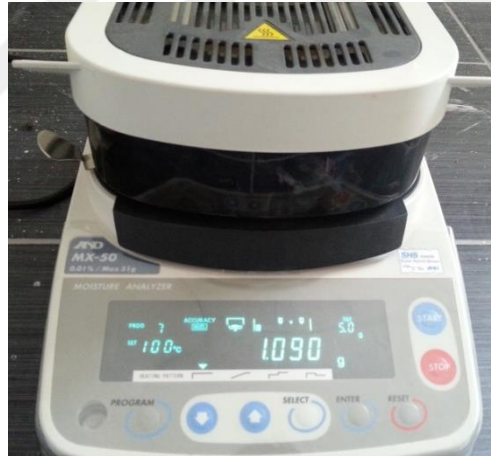
Şekil 3.22. Nem belirleme cihazı
