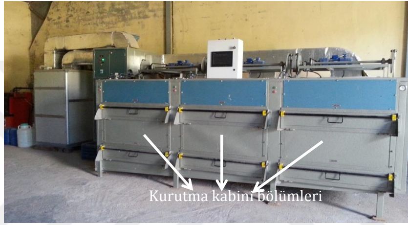
Şekil 3.5. Kurutma raflarının bulunduğu kurutma kabini ve bölümleri
