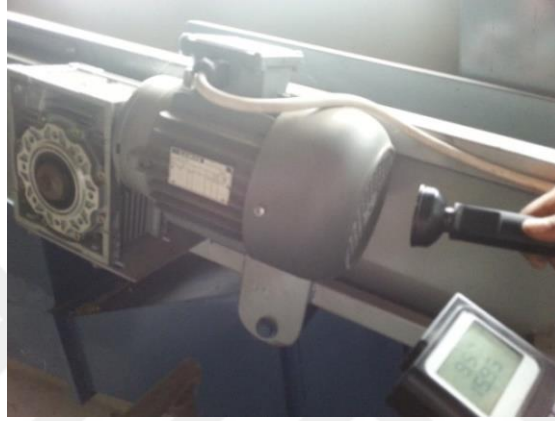
Şekil 3.40. Bant motoru devir sayısının ölçümü
