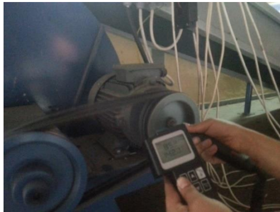
Şekil 3.41. Hava akımı ile ayırma sistemi fan motoru devir sayısının ölçümü
