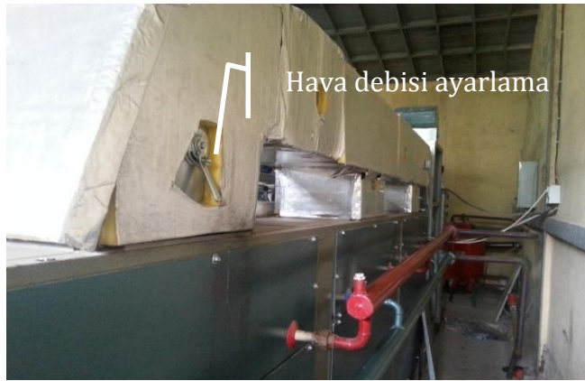
Şekil 3.14. Hava debisinin ayarlandığı kelebeklerin yerleşimi için bir örnek
