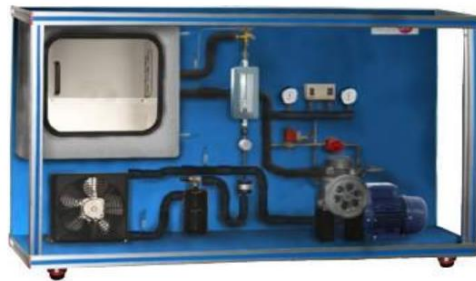
Şekil 5.24. Açık Kompresörlü Bilgisayar Kontrollü Soğutma Eğitim Seti (Edibon, 2017)
