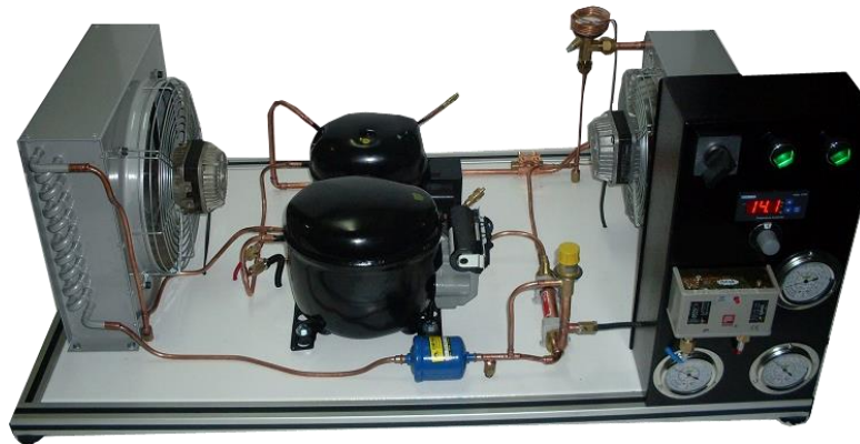
Şekil 5.7. İki Kademeli Ekonomizörlü Soğutma Eğitim Seti (Deneysan Katalog, 2017)
