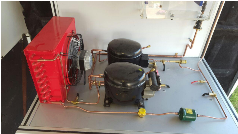
Şekil 5.13. Kademeli Soğutma Eğitim Seti Devresi(Deneysan Katalog, 2017)
