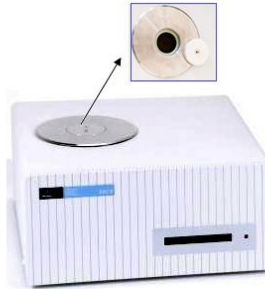
4.20 Diferansiyel Tarama Kalorimetri cihazı [60]
