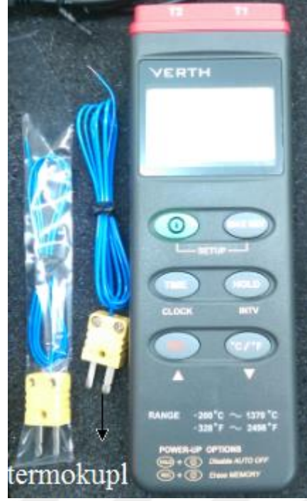
Şekil 4.15 Dijital sıcaklık ölçer ve termokupl
