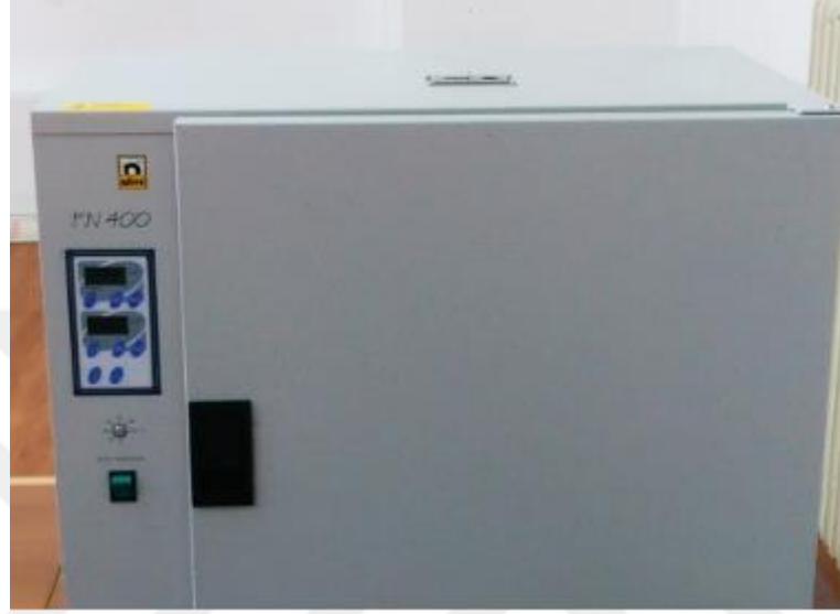
Şekil 4.14 Hava sterilizatörlü fırın
