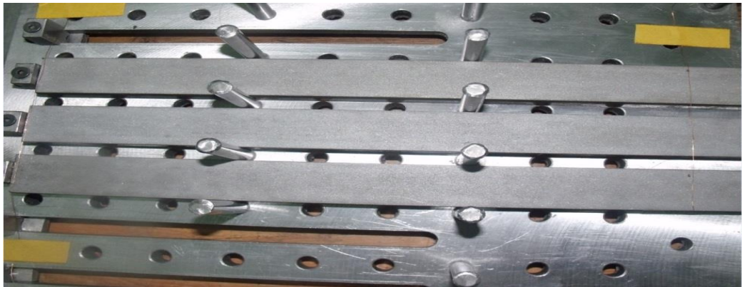
Şekil 4.7 Kumlama işlemi sonrası levha yüzeyleri
