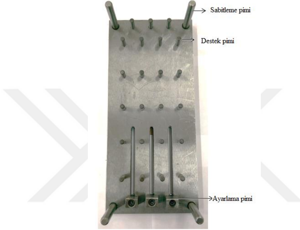
Şekil 4.12 Yapıştırma Bağlantı Kalıbı
