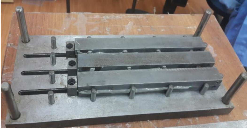
Şekil 4.33 Kalıp içerisinde ki yapıştırma bağlantıları
