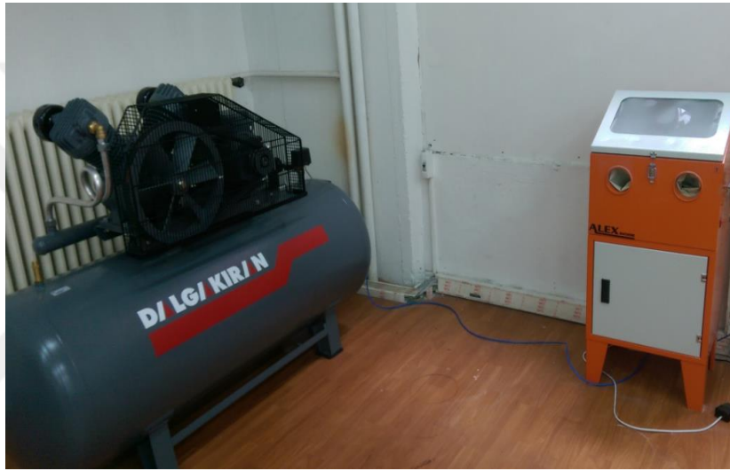
Şekil 4.6 Kumlama cihazı ve kompresör
