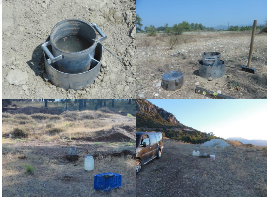
řekil 3.3. İnceleme alanında İnfiltrometre ile lm anından bir grnm
