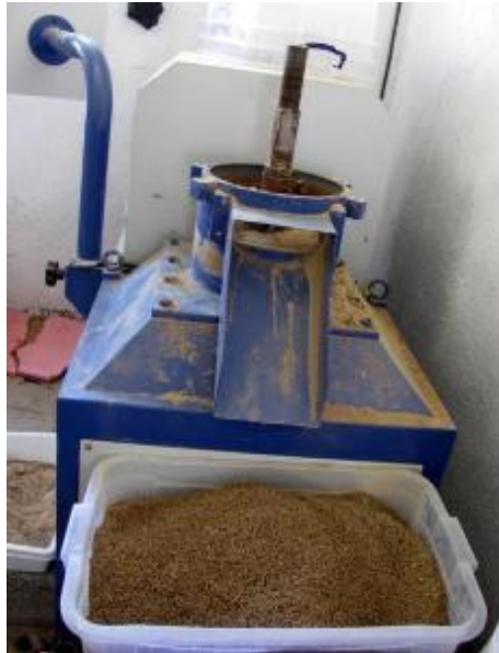
Şekil 3.9. Yem makinesi ile üretilen 2 mm'lik pelet yem (Orijinal).
