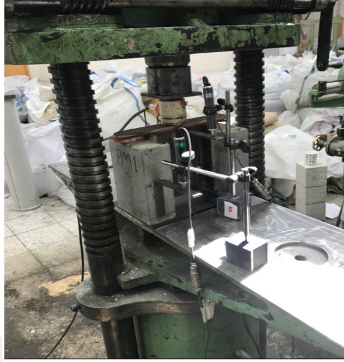
Şekil 3.26 : PM1 numunesi itme testi.
