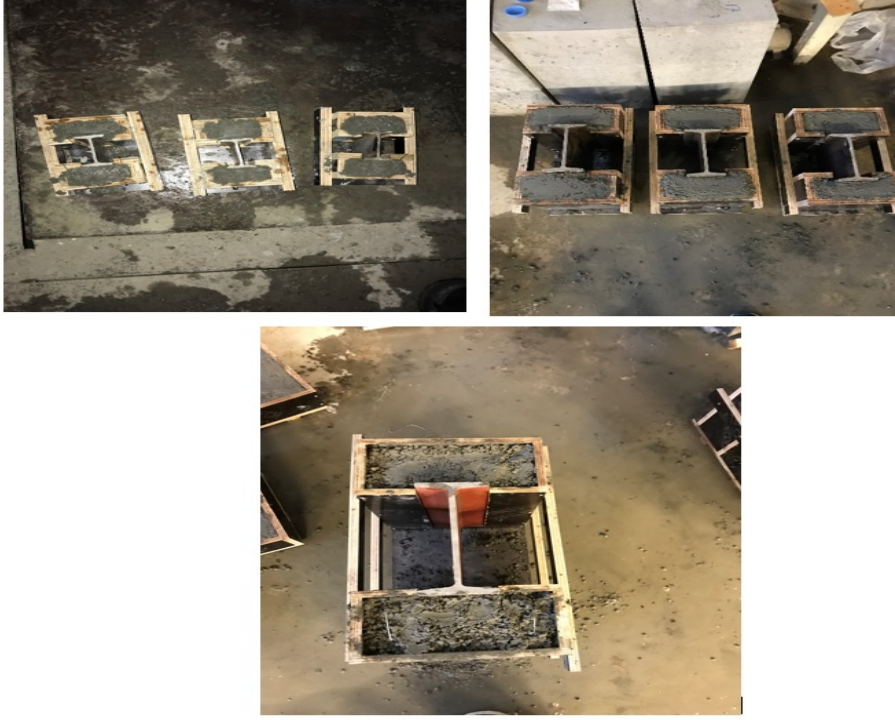
Şekil 3.4 : Numunelere beton dökülmesi.
