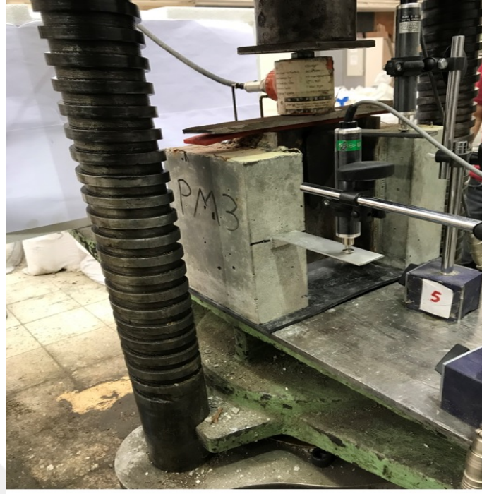
Şekil 3.30 : PM3 numunesi itme testi.
