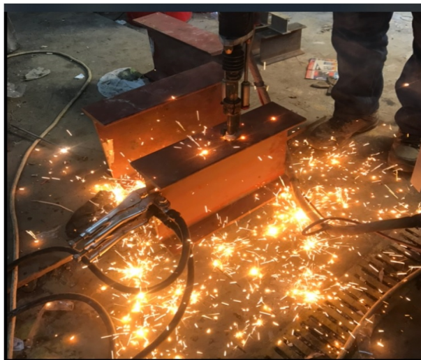
Şekil 1.6 : Stud çivisi montajı.
