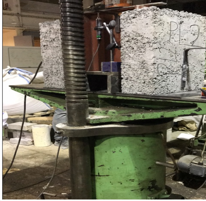
Şekil 3.22 : PL2 numunesi itme testi.
