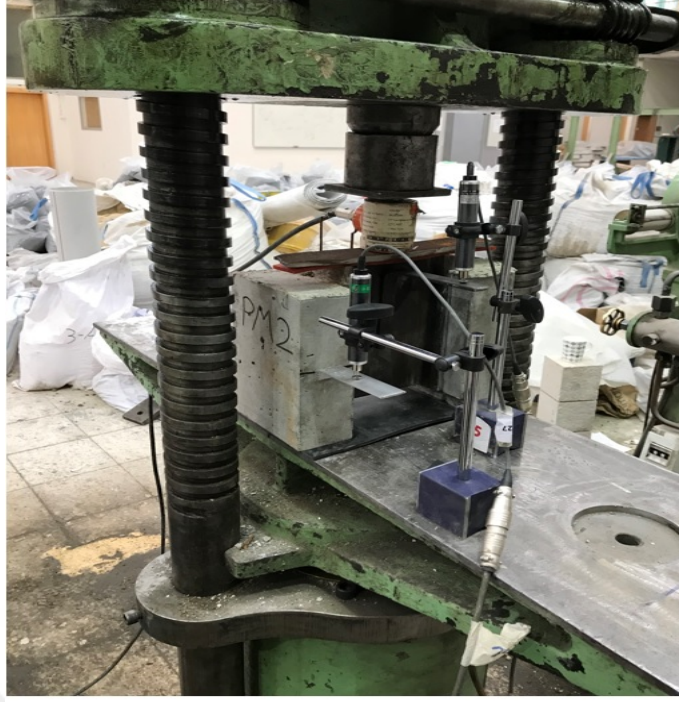
Şekil 3.28 : PM2 numunesi itme testi.
