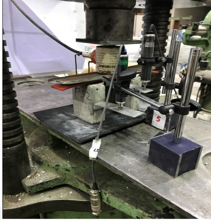
Şekil 3.34 : PS2 numunesi itme testi.
