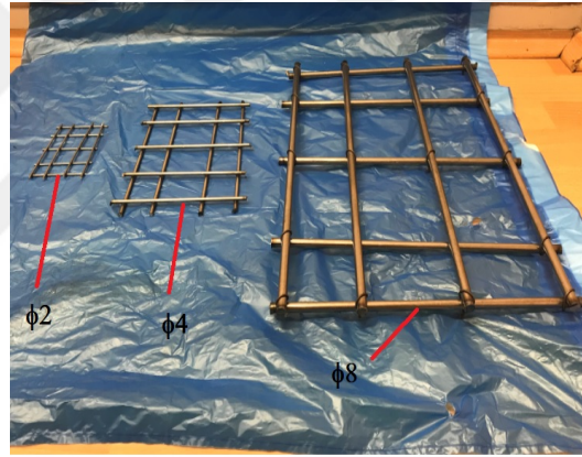
Şekil 3.16 : Deney için hazırlanan beton donatıları.
