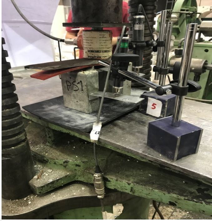
Şekil 3.32 : PS1 numunesi itme testi.
