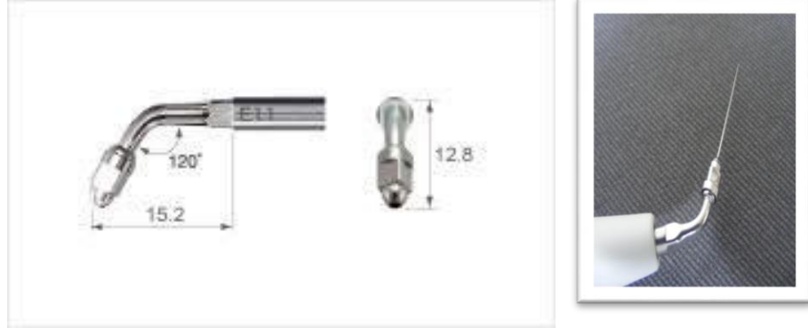
Resim 5.6. PUI'de ultrasonik cihaza takılan uç
