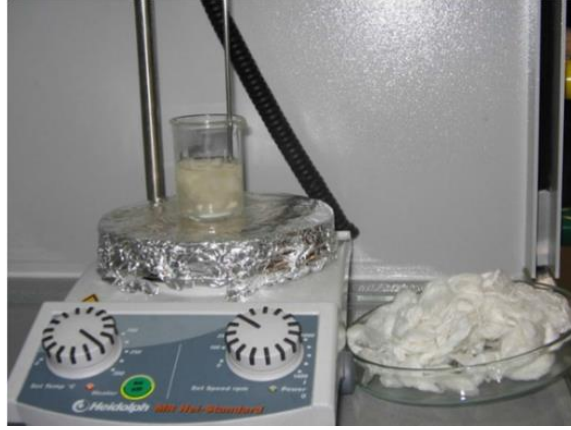
Şekil 3.8: İpek fibroini LiBr içerisinde çözme işlemi.
