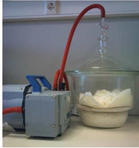
Şekil 3.7: Vakumlu desikatör içinde ipek fibroinin kurutulması.
