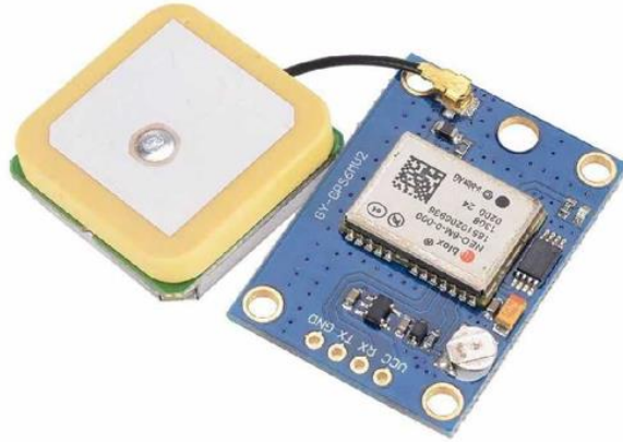
Şekil 3.9. GY-NEO6MV2 donanımın 4 adet bağlantı pini vardır. 25x25mm ve 25x35mm boyutlarındadır. Modül anten içermektedir. (GY-NEO6MV2 datasheet)
