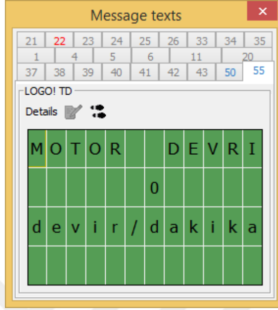
Şekil 10.3. Sirkülasyon pompa motorunun dakikadaki devir sayısını gösteren ekran.
