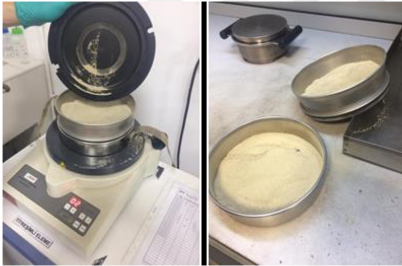
Resim 3.1 Titreşimli Elek Analizi ve Elek Altı Numuneler
