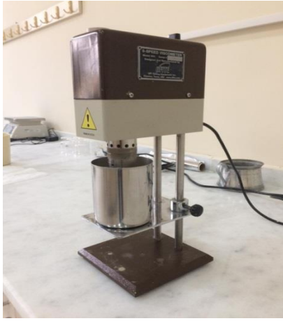
Resim 2.3 Fann Model 8 Hızlı Döner Viskozimetre
