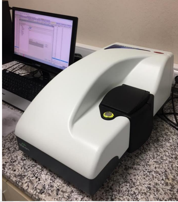
Şekil 5.1 Parçacıkların boyutsal ölçümü için kullanılan test cihazı (Kişisel arşiv, 2019)
