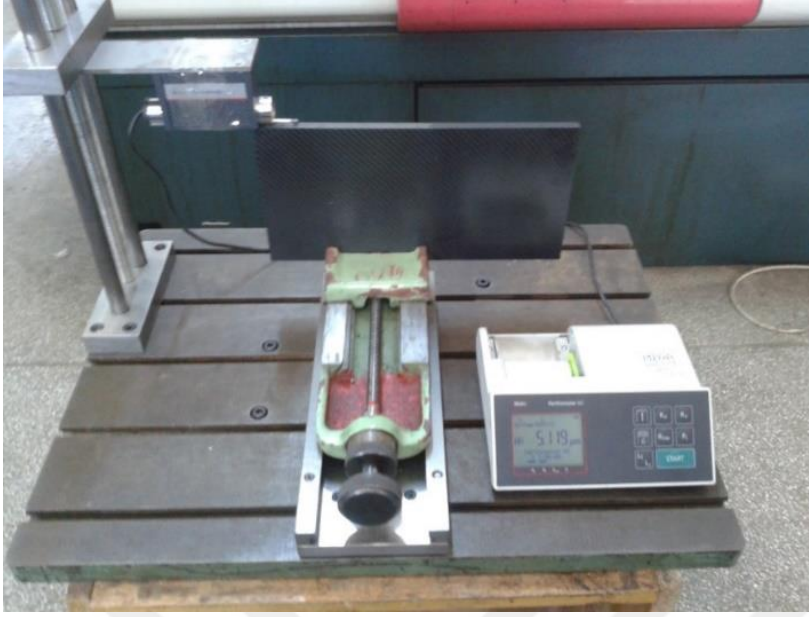
Resim 4.1. Yüzey pürüzlülük ölçüm düzeneği
