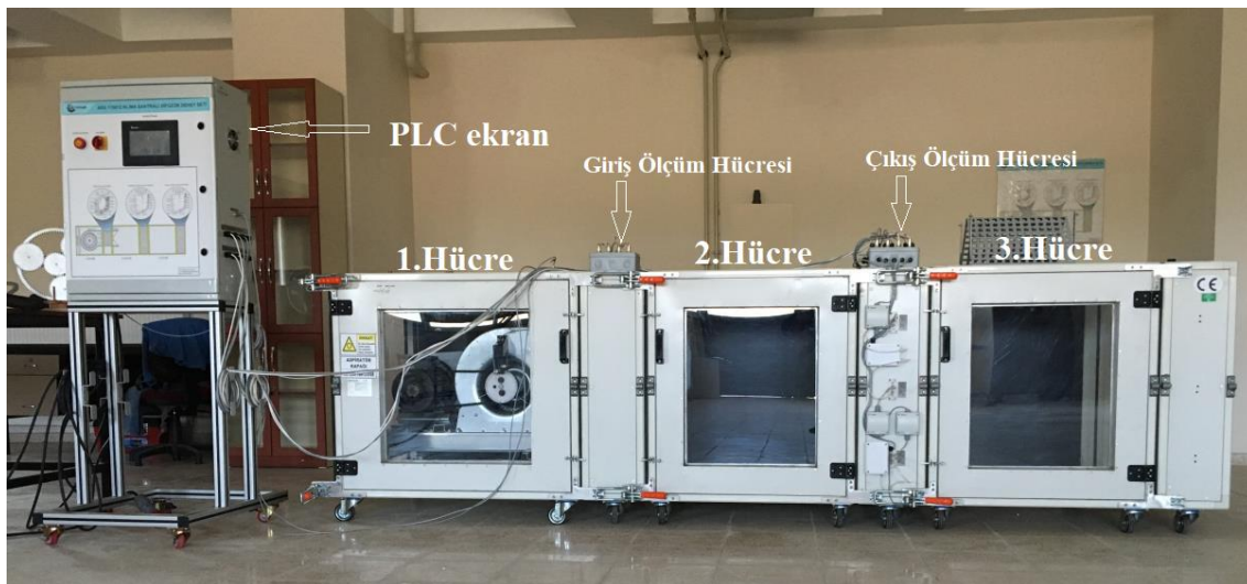
Şekil 4.14. Klima santrali deney düzeneği
