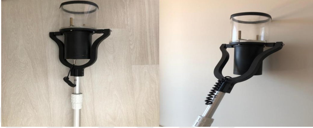
Şekil 4.7. Duman dedektörü test aparatının montajlanmış hali
