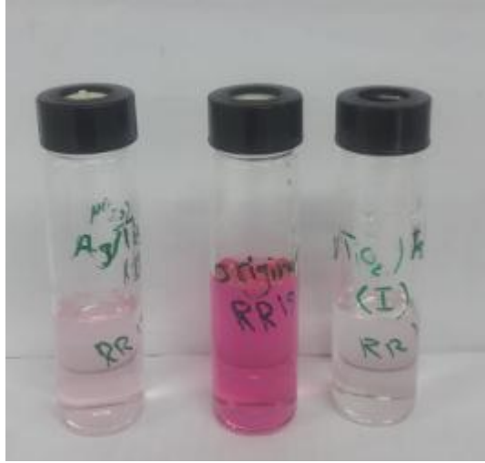
Şekil.31. Ag/TiO 2 /Fe 3 O 4 (I) ve Ag/TiO 2 /Fe 3 O 4 (II) katalizörüyle RK195 sonofotodegradasyon sonunda giderimi
