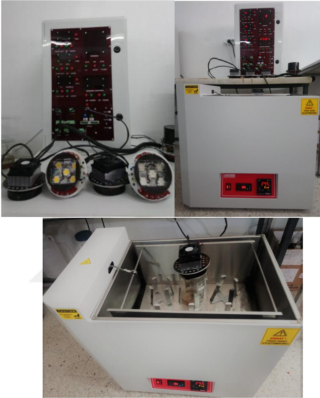
Şekil.7. UV ve görünür lambaların kontrol paneli ve reaktör düzeneği
