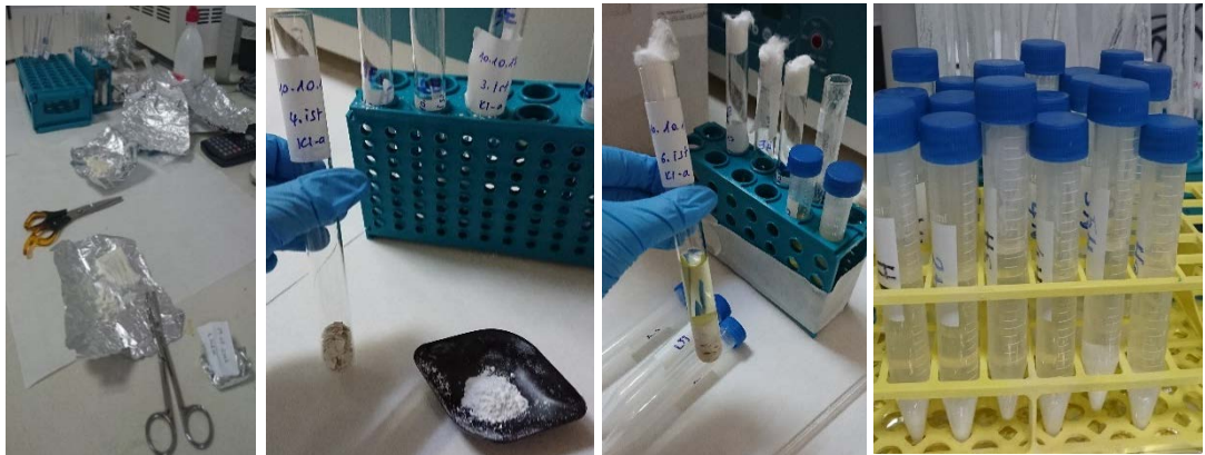
Şekil 3.10. Filtre kâğıtlarını kesme işlemi ve tüplere aktarımı, %90'lık aseton ile klorofil-a ekstraksiyonu, santrifüj işlemi hazırlığı
