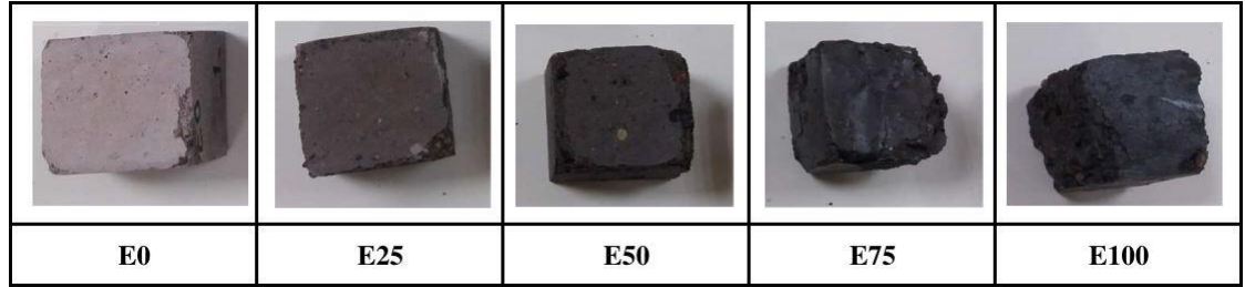
Şekil 4.8. 50 donma-çözülme çevrimi sonrası numunelerin görsel incelemesi
