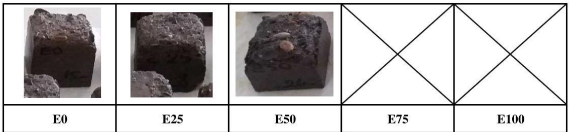
Şekil 4.13. 300 donma-çözülme çevrimi sonrası numunelerin görsel incelemesi
