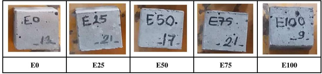
Şekil 4.3. Kontrol numunelerin kür sürelerini tamamladıktan sonra görünüşleri
