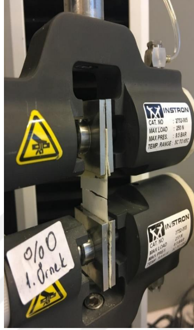
Şekil 3.25. Çekme testinin gösterimi
