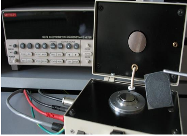
Şekil 4.10 Minyatür ölçüm hücresi ve içyapısı (Kara vd., 2010)
