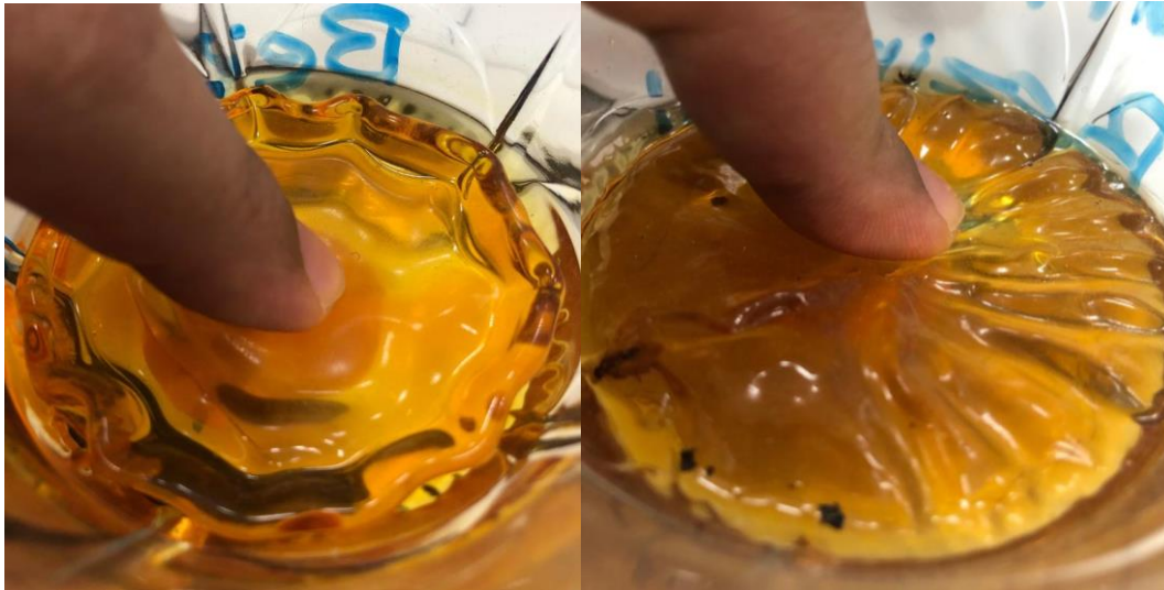
Şekil 4.10 : Nisan 2019, İngiliz nevi (ince) bezir yağı (sol) ve Türk nevi (kalın) bezir yağı (sağ) üzerinde oluşan katman.
