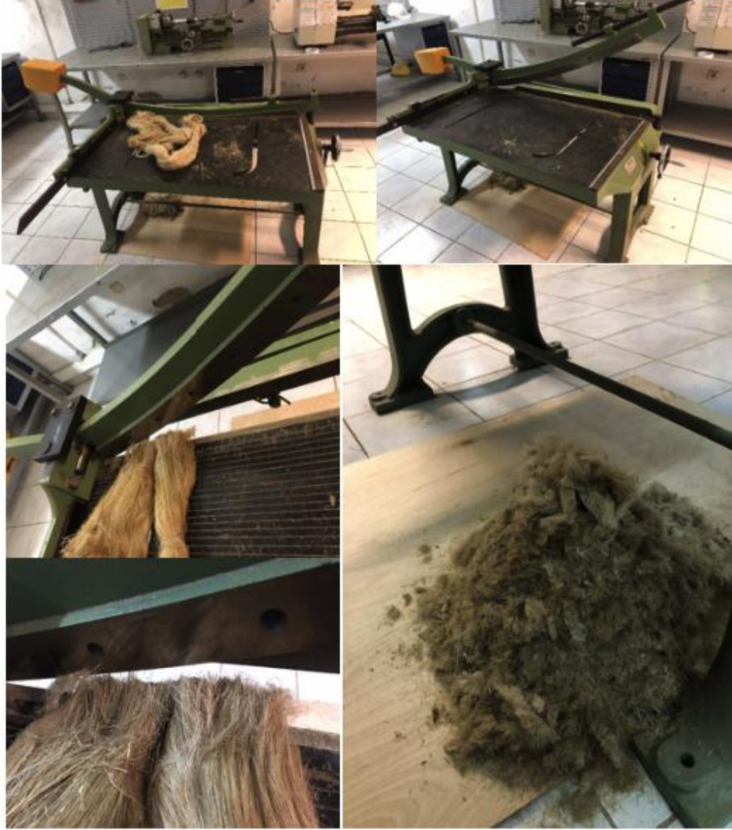
Şekil 4.7 : Keten liflerin kesiminde kullanılan mekanik giyotin makas makinesi.
