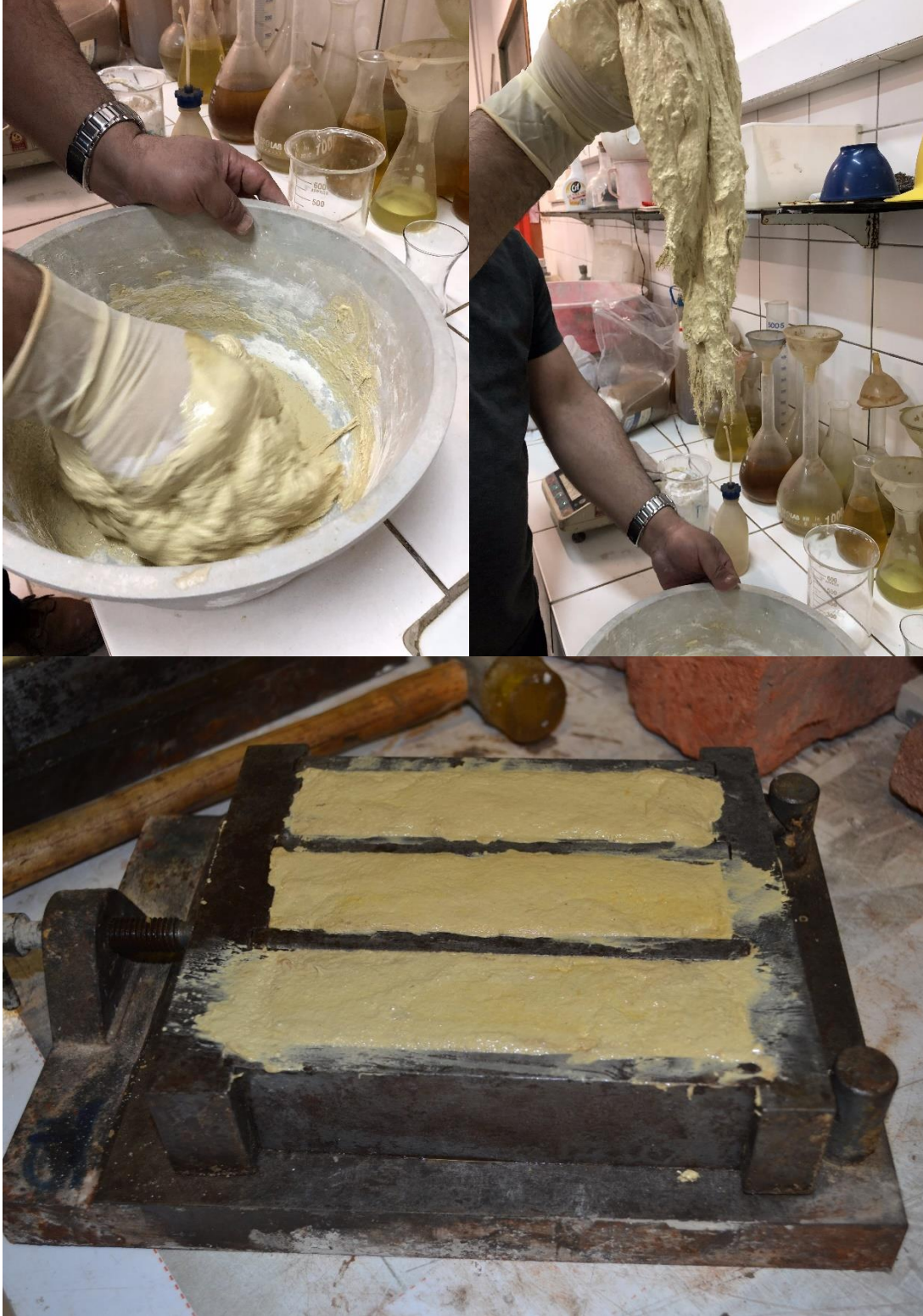
Şekil 4.14 : Lifli ince-lökünün yoğurulması ve kalıplanması.
