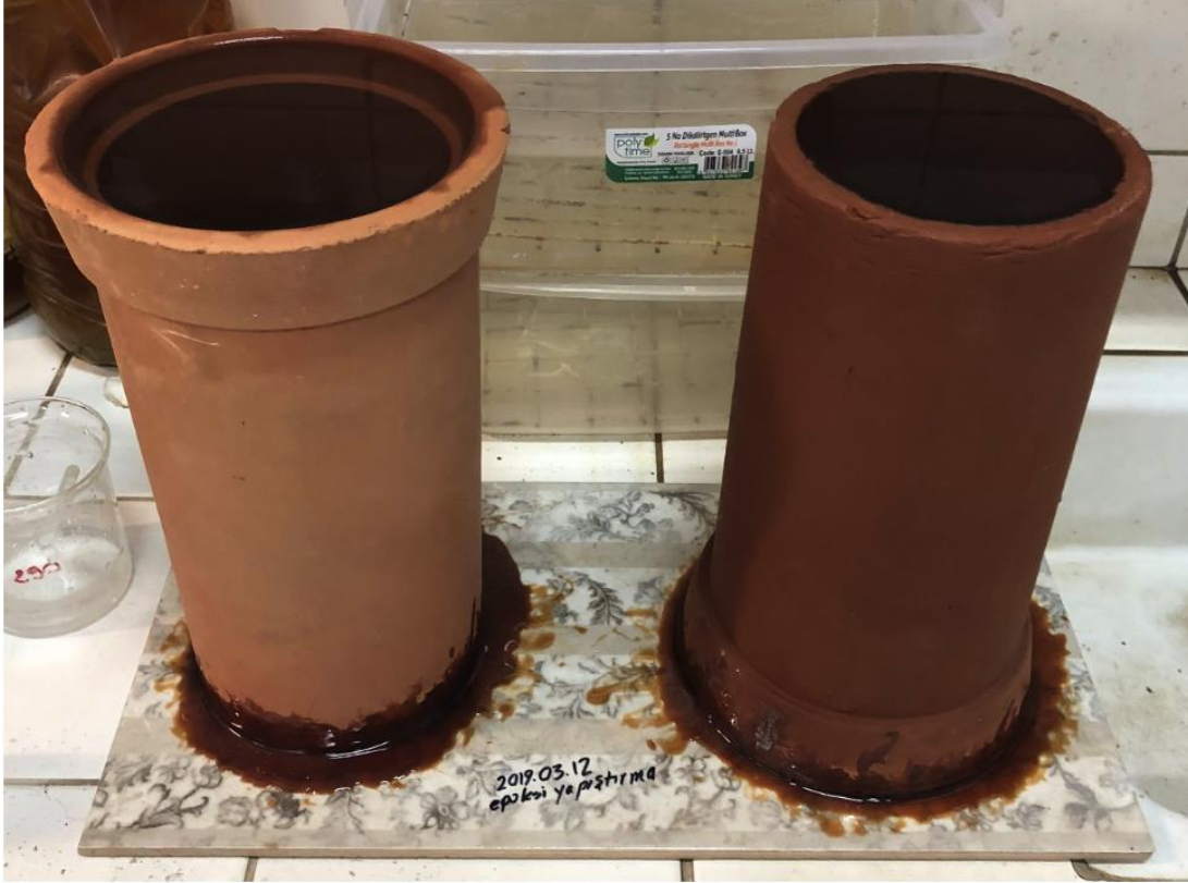
Şekil 4.32 : 1 saat arayla suyla doldurulan künklerin, yaş ve kuru yüzeylerin arasındaki renk farkı.
