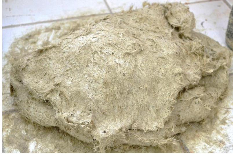
Şekil 4.37 : Keten liflerinin balyoz darbesi ile löküne yedirilmesi.
