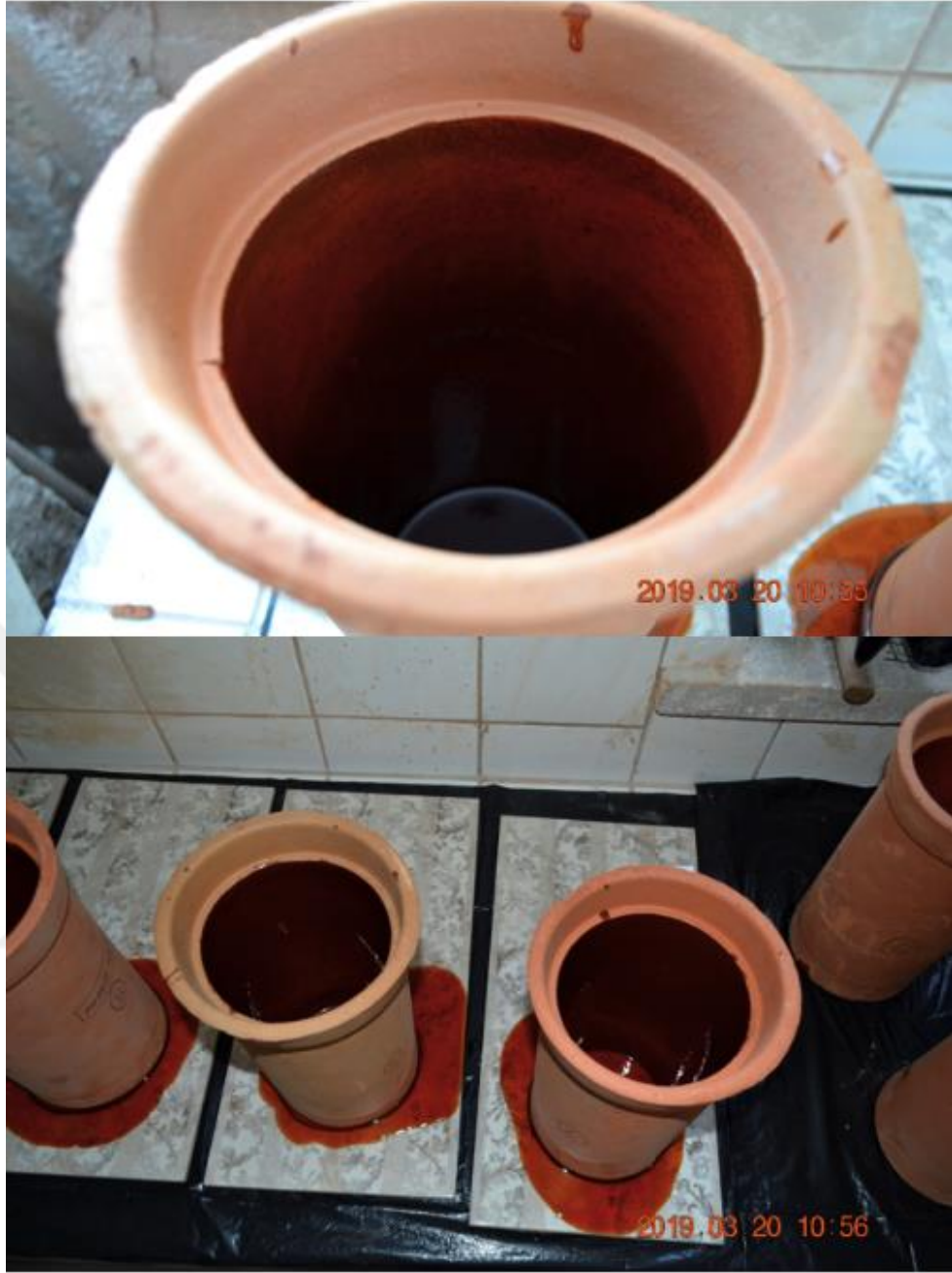
Şekil 4.34 : İç kısmına epoksi yapıştırıcı uygulanarak, geçirimsiz hale getirilen künkler.
