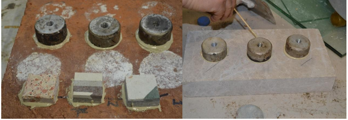
Şekil 4.15 : Tuğla ve taş yüzeylerine uygulanan lifsiz ince-lökün.
