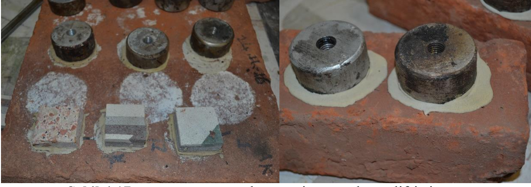
Şekil 4.17 : 24 saat sonra tuğla yüzeyine uygulanan lifsiz ince-lökün.
