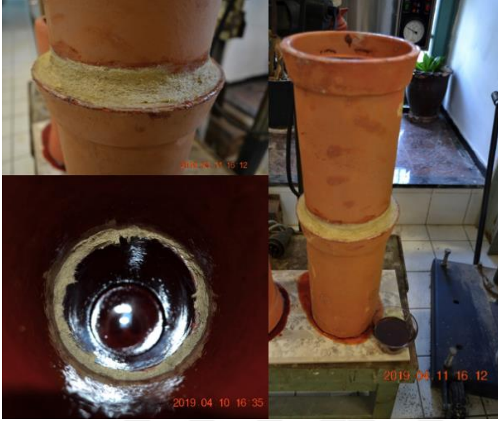
Şekil 4.41 : Künklerin bağlantı noktalarına uygulanan lökün.
