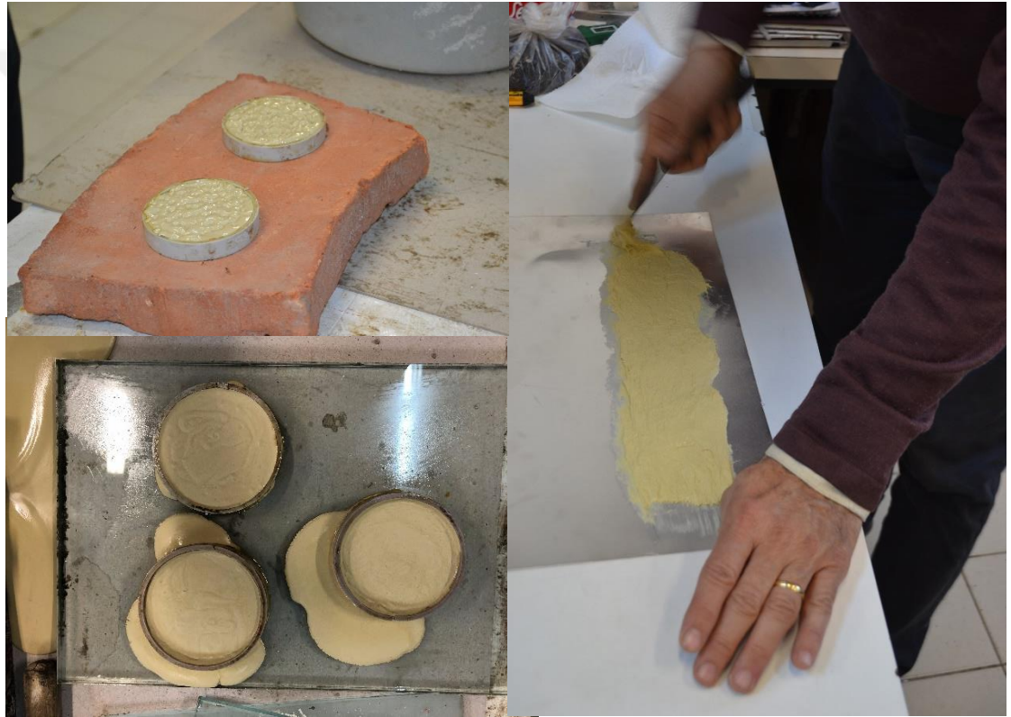
Şekil 4.16 : Tuğla ve taş yüzeylerine uygulanan lifsiz ince-lökün (sol), alüminyum levha yüzeyine uygulanan lifli ince-lökün katmanı (sağ).
