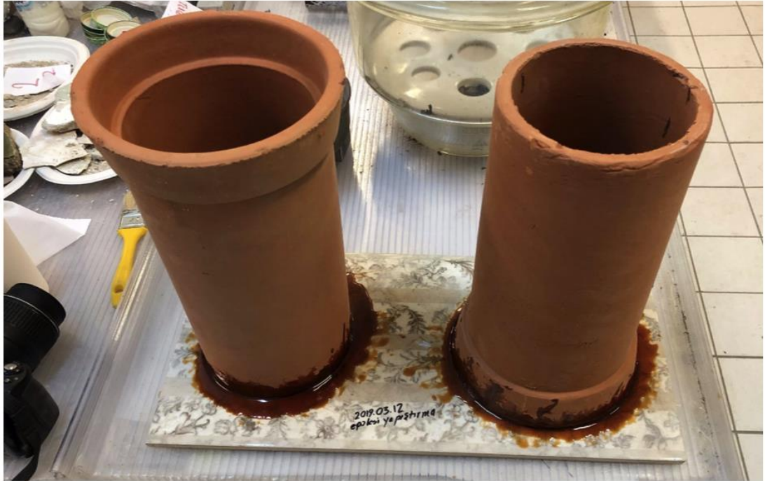
 ekil 4.31 : Toprak k nklerin epoksi yapı tırıcı ile suge irmez y zeye (seramik) yapı tırılması.
