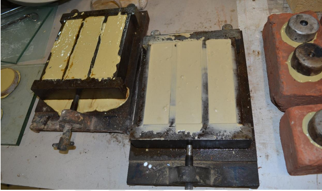
Şekil 4.11: Lifsiz ince-lökün (sağ) ve lifsiz kalın-lökün (sol). yapımı
