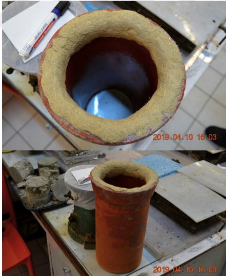
Şekil 4.38 : Künkün geniş tarafına lökün uygulanması.
