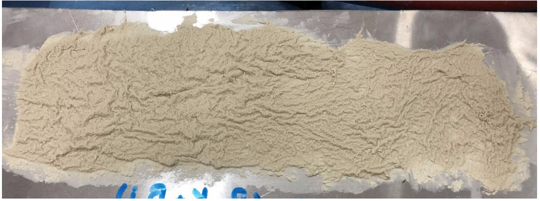
Şekil 4.21 : Uygulamadan 3 gün sonra, alüminyum levhaya sürülen lifli ince-lökün
