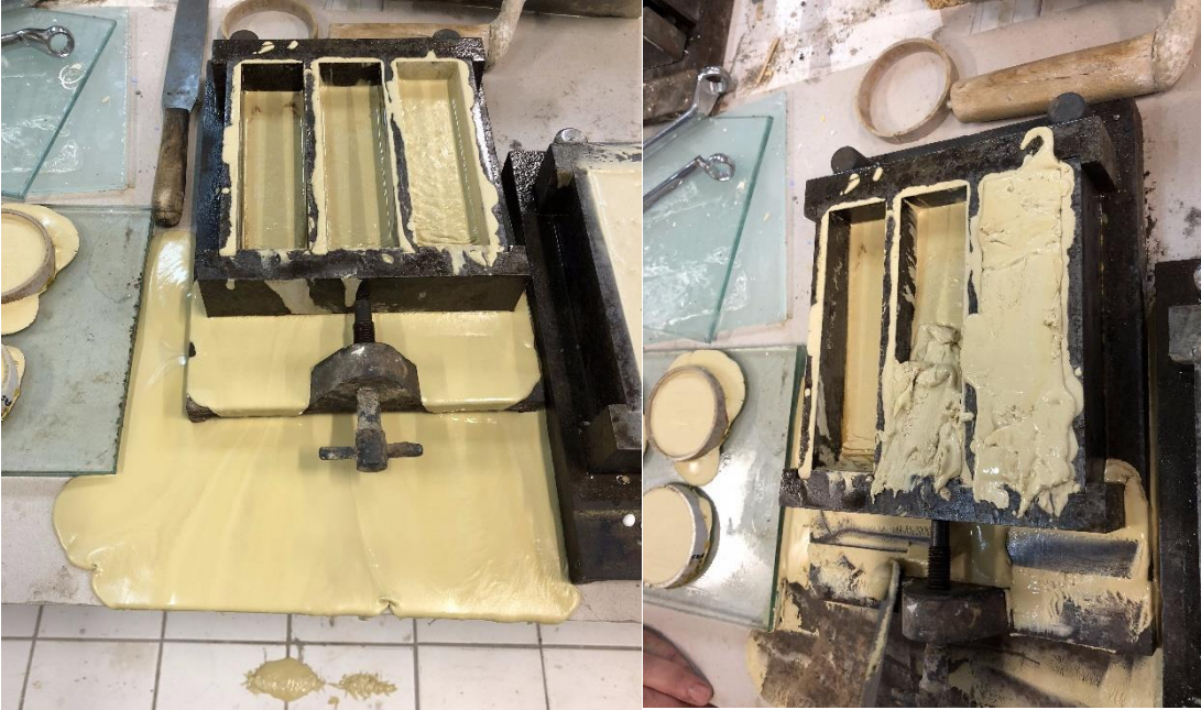
Şekil 4.12 : Lifsiz ince-lökünün kalıptan akması ve tekrardan kalıplanması.
