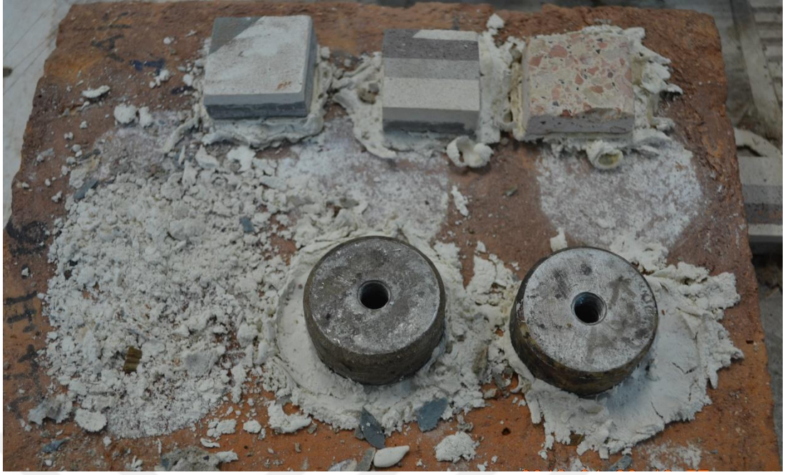
Şekil 4.20 : Uygulamadan bir hafta sonra, tuğla üzerine uygulanan lifsiz ince-lökünün ufalanması.
