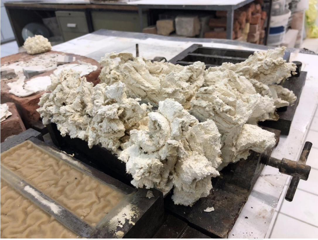
Şekil 4.27 : Uygulamadan 3 ay sonra, 12 Haziran 2018 tarihinde, Lifsiz kalın-lökün (sol) ve lifli ince-lökün (sağ).
