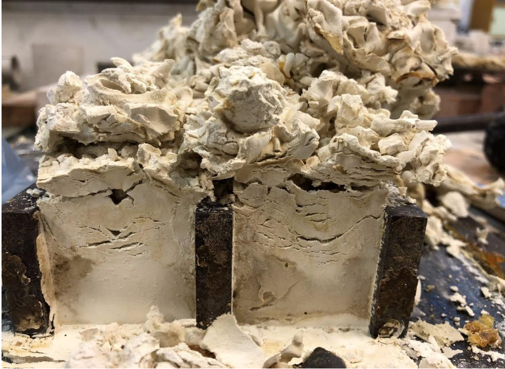
Şekil 4.30 : Uygulamadan 13 hafta sonra, 2 Ağustos 2018 tarihinde, farklı açılardan lifsiz kalın-lökün.
