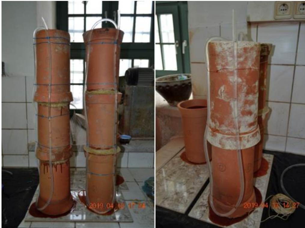
Şekil 4.42 : İkili ve üçlü deney künklerin suyla doldurulması ve su seviyesini gösteren terazi hortumu.
