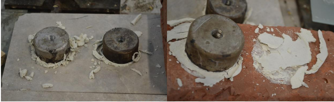
Şekil 4.18 : Uygulamadan bir hafta sonra, taş ve tuğla üzerine uygulanan lifsiz ince-lökünün ufalanması.
