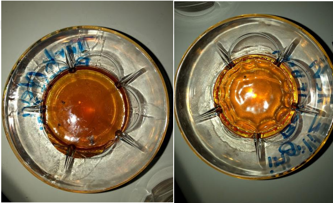
Şekil 4.6 : Türk nevi (kalın) bezir yağı (sol) ve İngiliz nevi (ince) bezir yağı (sağ) arasındaki renk farkı.
