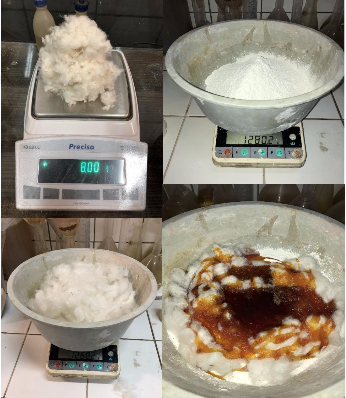
Şekil 4.13 : Lifli ince-lökünün yapımı.
