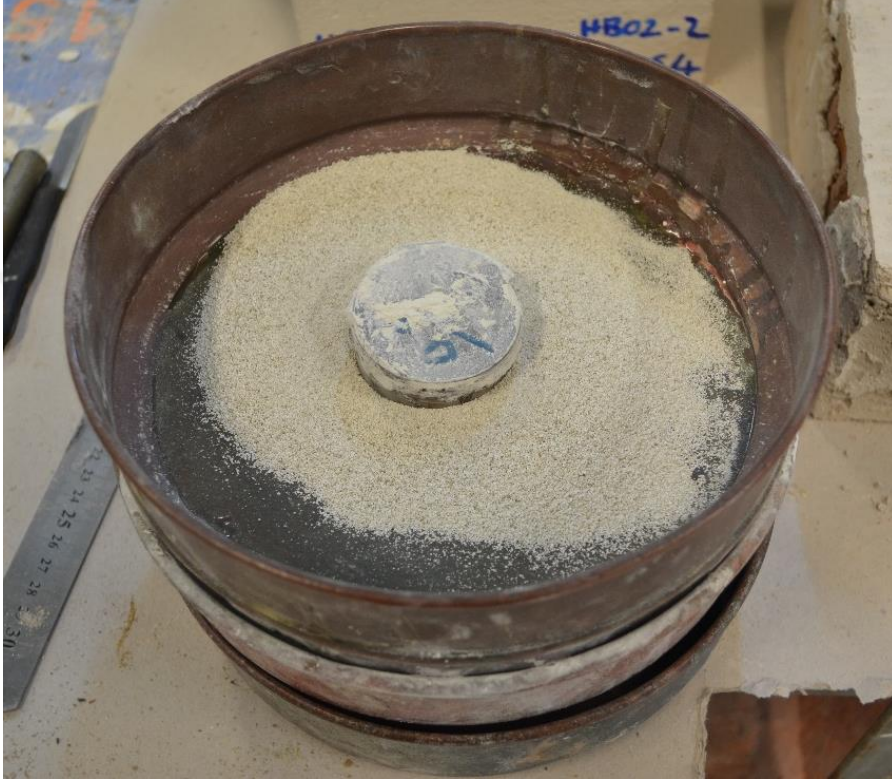
Şekil 4.4 : Sönmemiş kireç tozu 0.50 ve 0.212 elekten geçirilmesi.
