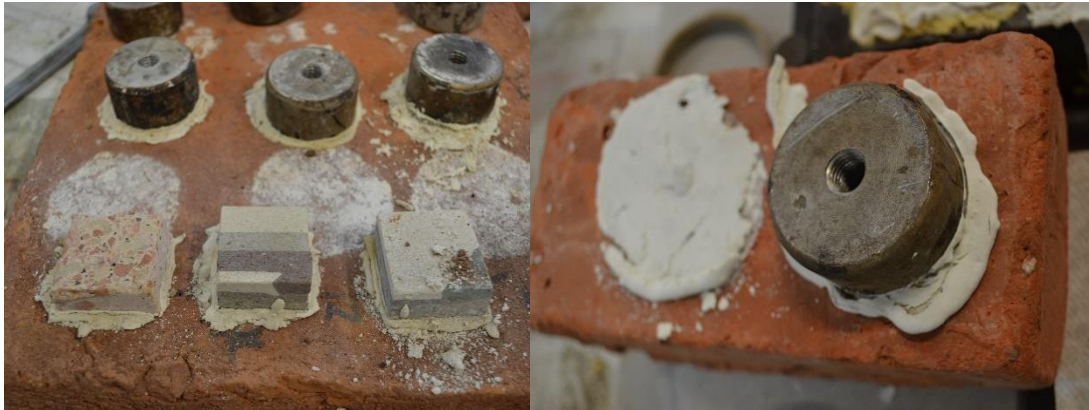
Şekil 4.19 : 3 gün sonra tuğla yüzeyine uygulanan lifsiz ince-lökün.
