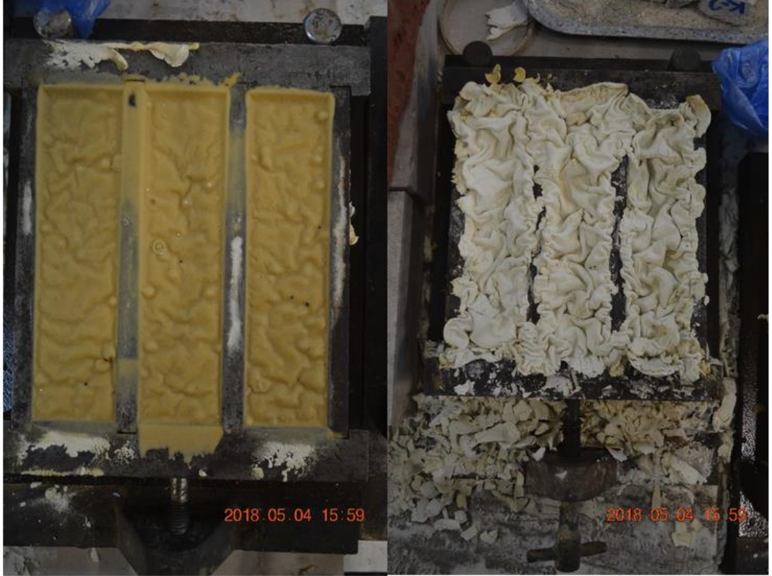
Şekil 4.26 : uygulamadan 3 hafta sonra, lifsiz kalın-lökün (sağ) ve lifsiz ince-lökün (sol).
